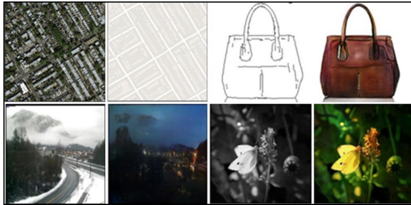
Figura 40 – Exemplos de imagens produzidas pela rede pix2pix tendo como entrada uma imagem condicionante, imagem de satélite para mapas, bordas para fotos, dia para noite e foto em tons de cinza para foto colorida.
