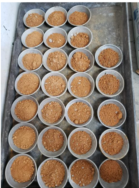
Figura 36 – Cápsulas com material para determinação da umidade
