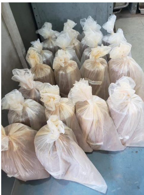
Figura 39 – Corpos de prova compactados e armazenados aguardando o tempo de cura
