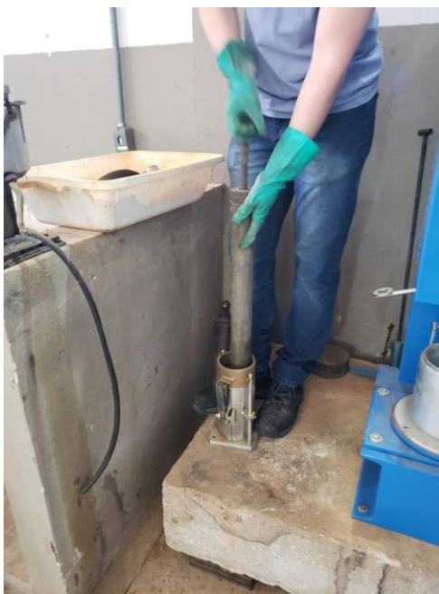
Figura 35 – Compactação com compactador manual
