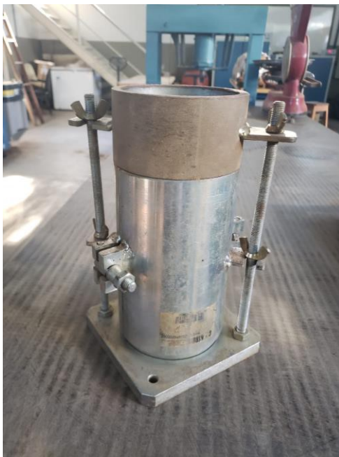
Figura 31 – Molde bipartido utilizado nos ensaios, montado
