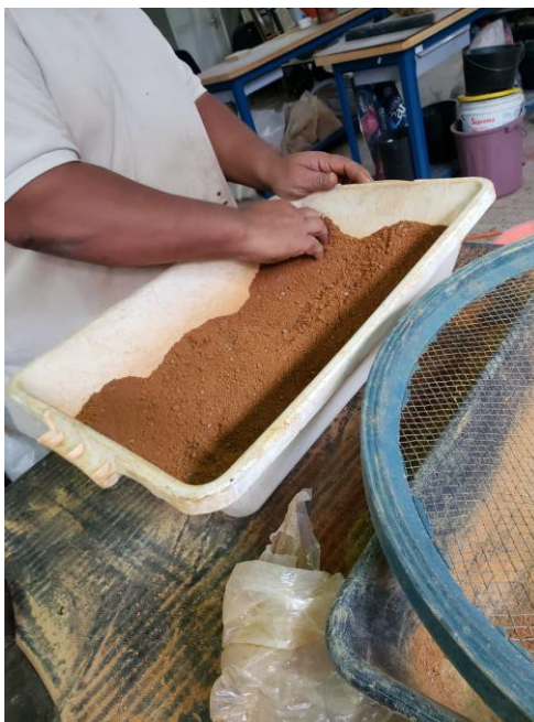
Figura 30 – Homogeneização final imediatamente antes à compactação
