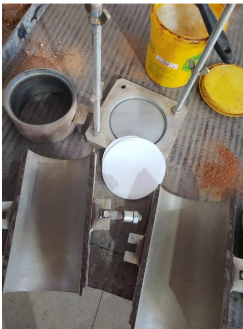
Figura 32 – Partes do molde bipartido e materiais utilizados em sua montagem
