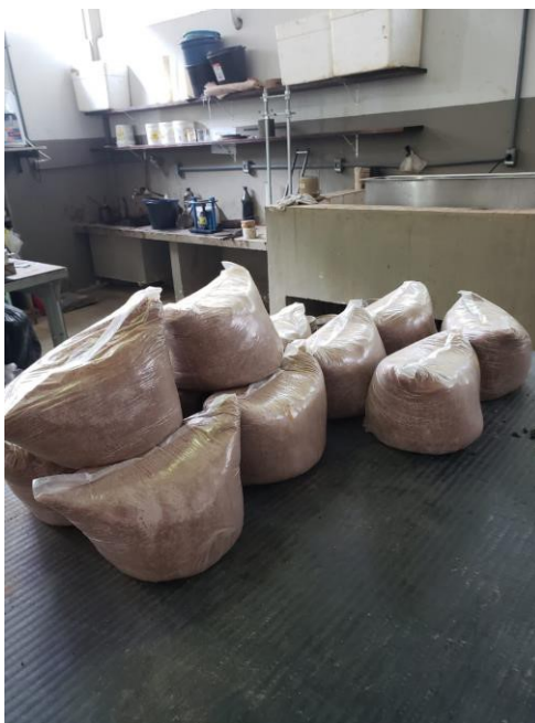
Figura 29 – Material homogeneizado e embalado para descanso antes da compactação
