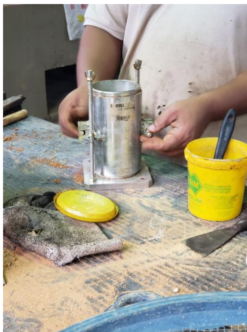
Figura 33 – Montagem do molde bipartido
