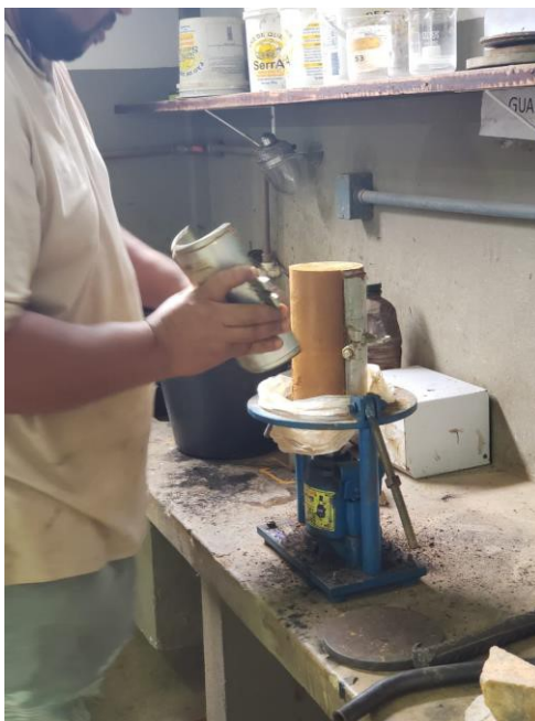
Figura 38 – Extração do CP do molde
