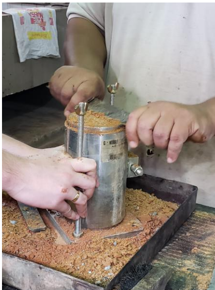
Figura 37 – Correção do topo do CP
