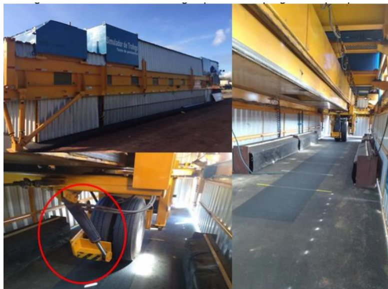
Figura 27 – Simulador de tráfego tipo HVS utilizado em campo (destaque da unidade hidráulica)
