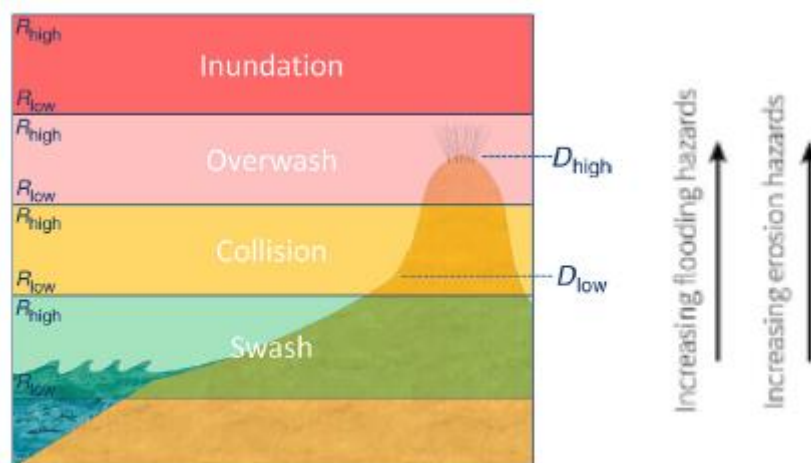
Figura 4 – Exemplos dos quatro regimes de impacto de tempestades de acordo com Sallenger (2000), onde R_{low} (elevação mínimo do nível da água), R_{high} (elevação máxima do nível da água), D_{low} (base da duna) e D_{high} (topo da duna) Fonte: adaptado de Castelle & Harley (2020).
