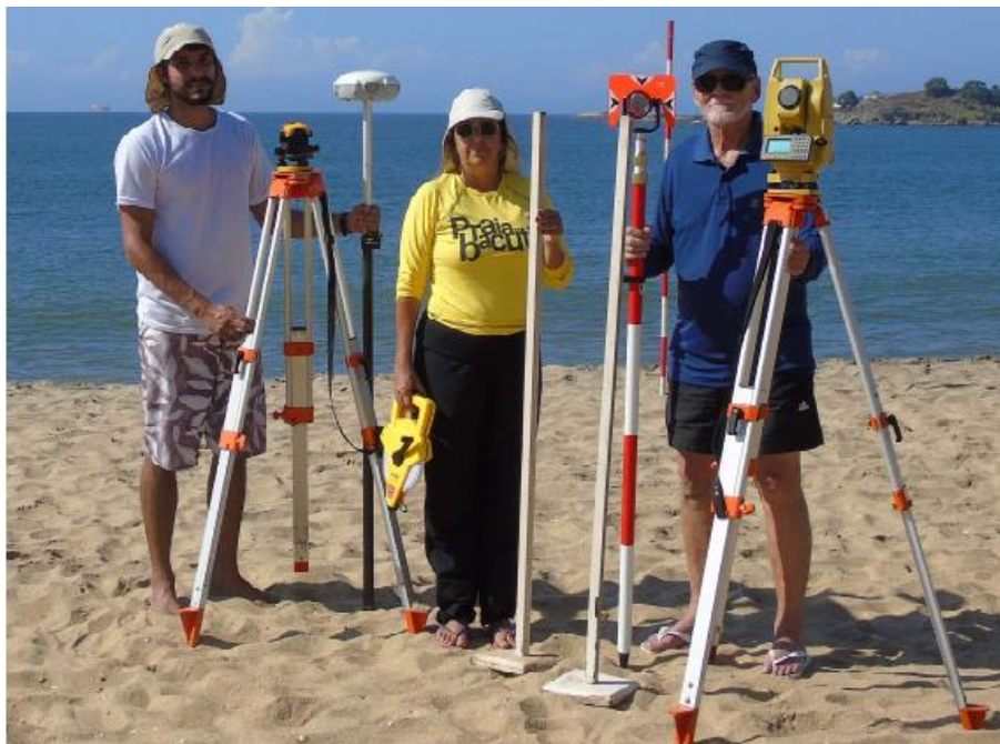
Figura 6 – Equipamentos para realizar o perfil de praia, da esquerda para a direita: nível topográfico, RTK, balizas de Emery, Estação Total. Foram utilizados em campo somente o nível topográfico e RTK. Fonte: Muehe et al. (2020).
