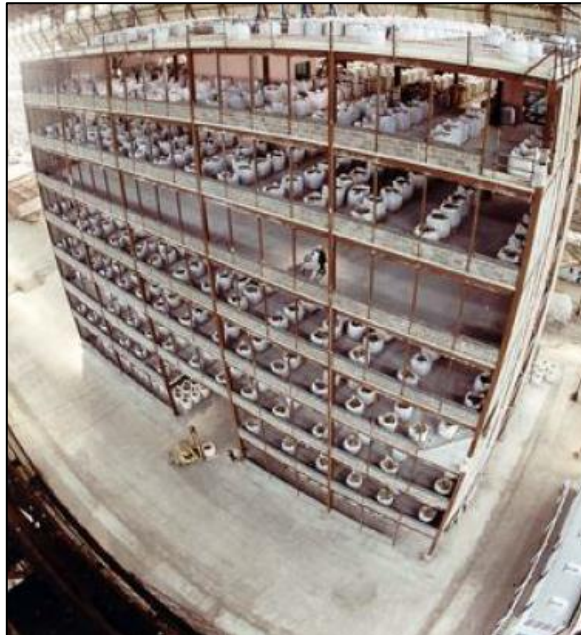
Figura 23 – Prédio ensaiado no laboratório de Cardington.
