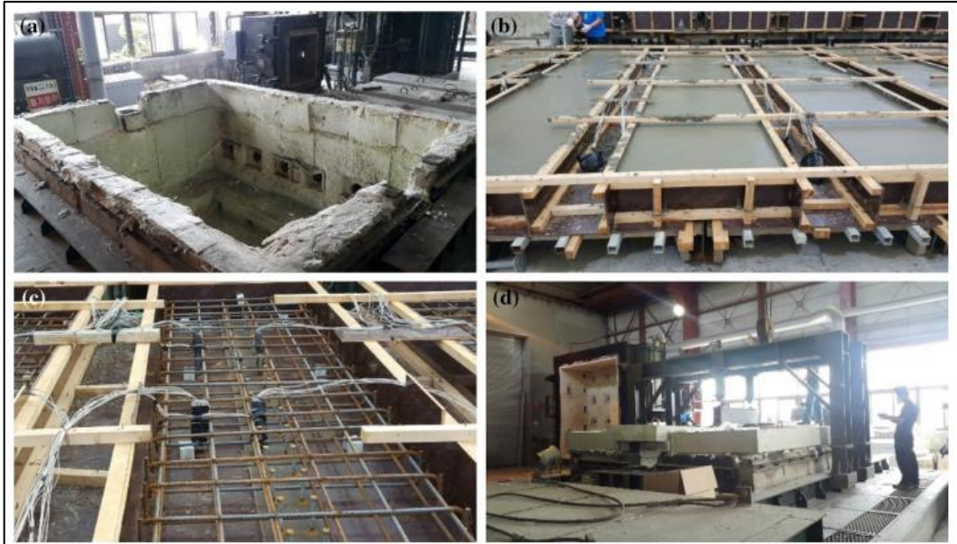
Figura 26 – Experimento realizado em viga mista em alta temperatura; (a) forno utilizado no experimento; (b) concretagem da laje; (c) instrumentação do elemento estrutural; (d) viga mista dentro do forno.
