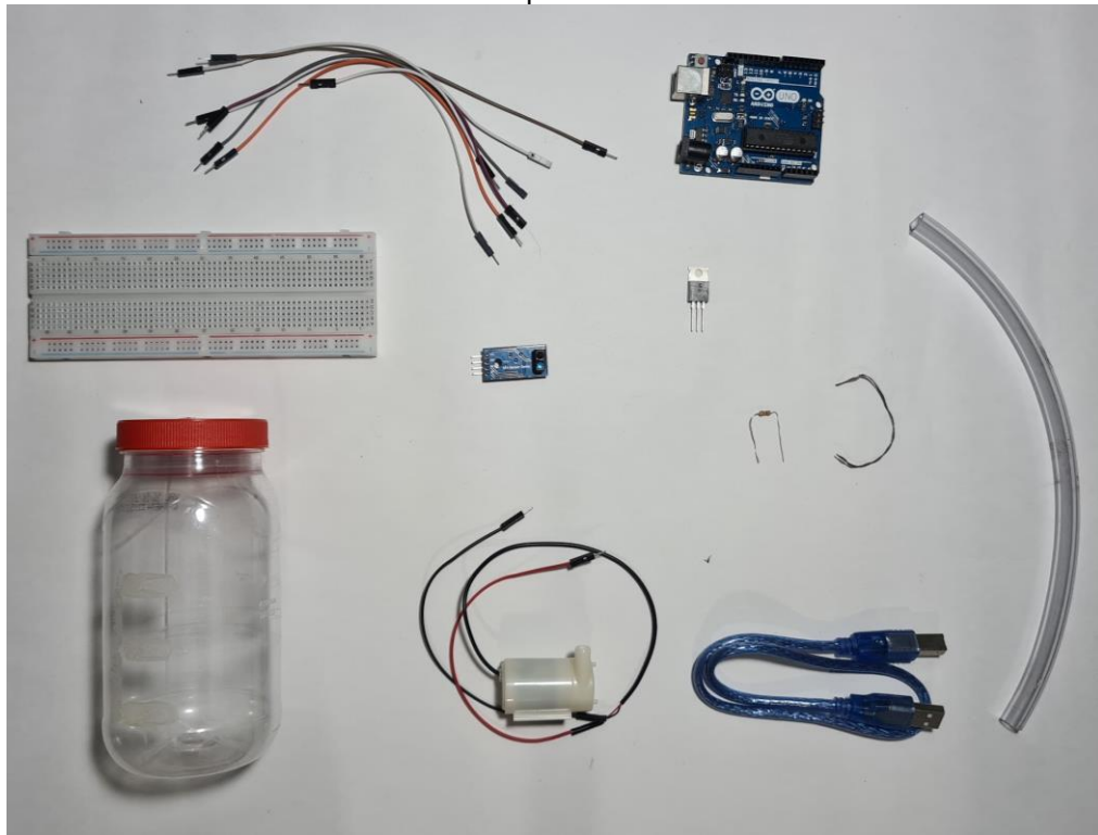
Figura 2: Vista superior dos materiais necessários para montagem do distribuidor automático de líquidos.
