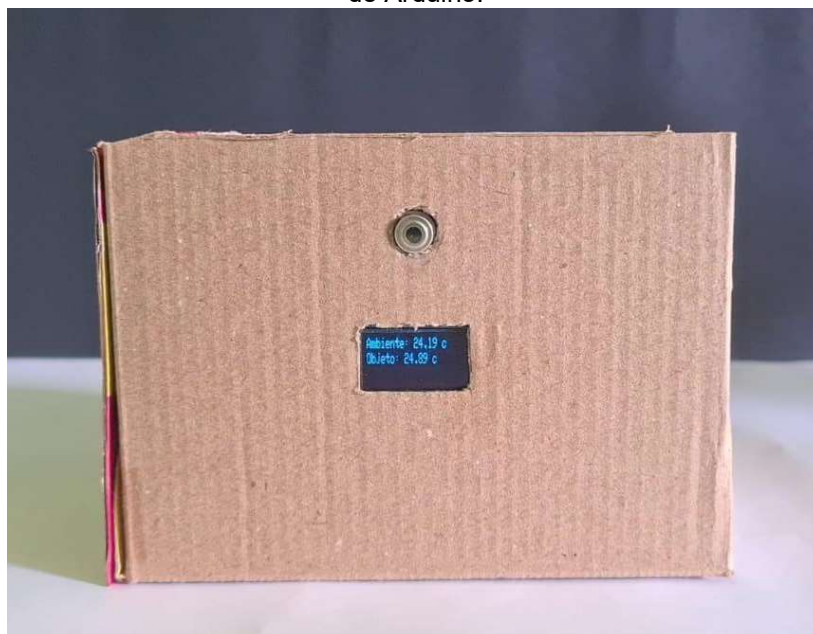
Figura 3 - Proposta experimental do produto educacional: Termômetro infravermelho feito com placa de Arduino.
