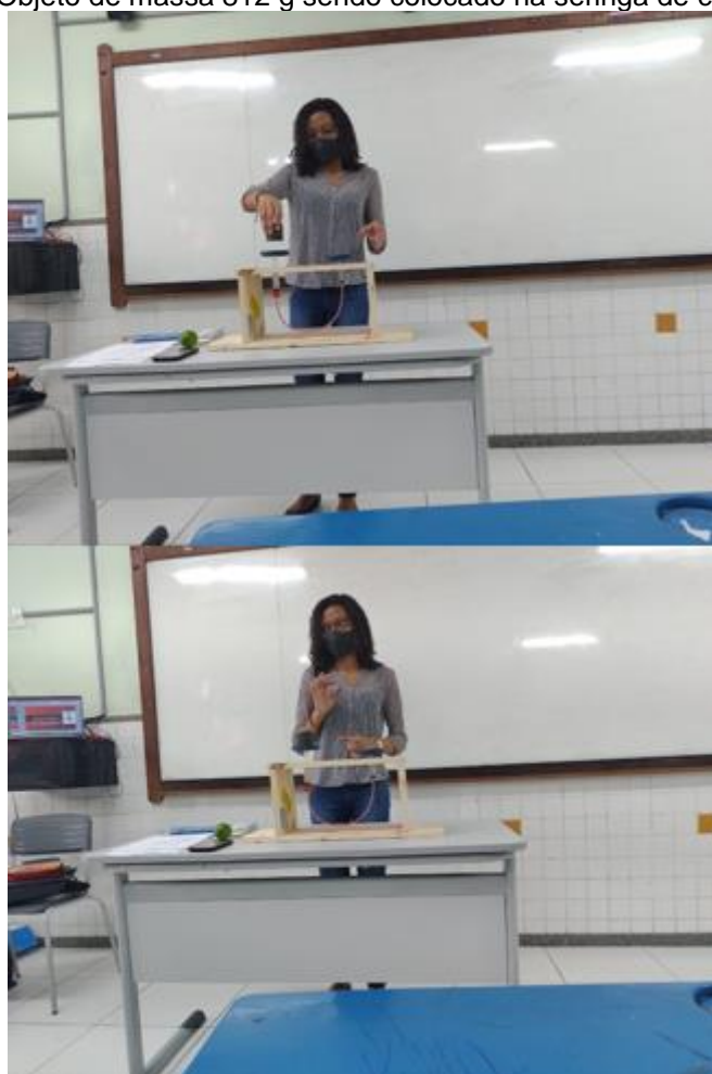
Figura 37 - Objeto de massa 812 g sendo colocado na seringa de êmbolo maior.
