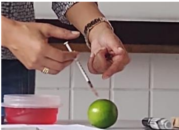
Figura 23 – Aplicabilidade do princípio de Pascal: seringa de injeção.
