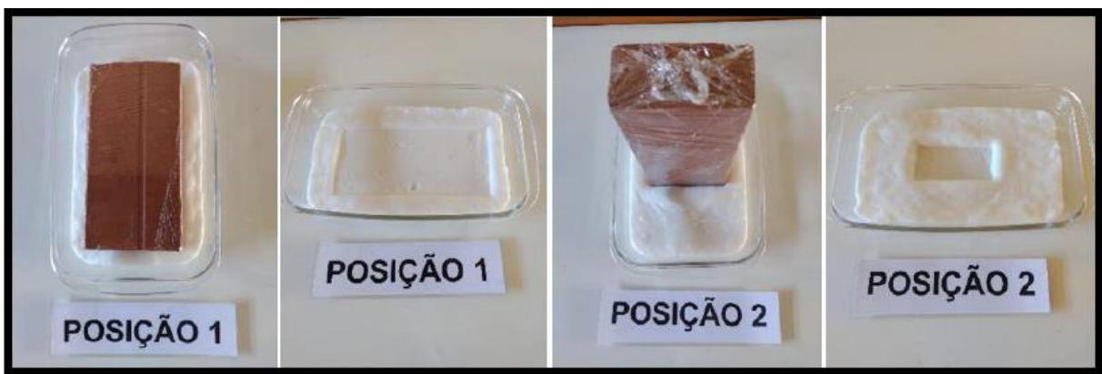
Figura 9 – Pressão dos blocos numa superfície maleável.
