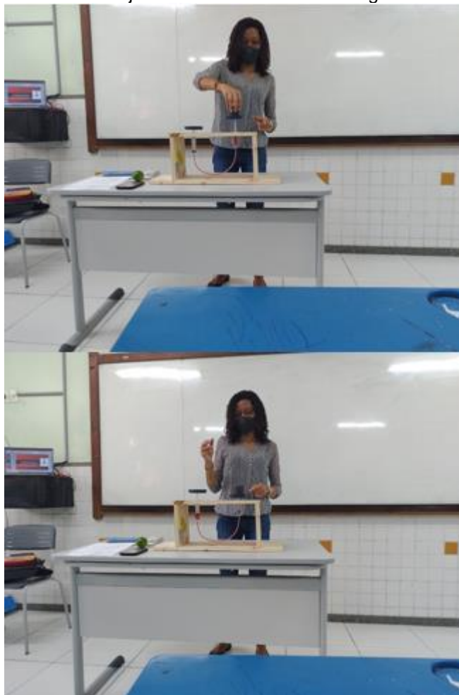
Figura 38 - O mesmo objeto sendo colocado na seringa de êmbolo menor.
