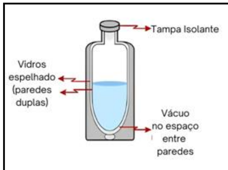
Figura 9 - Representação de uma garrafa térmica.
