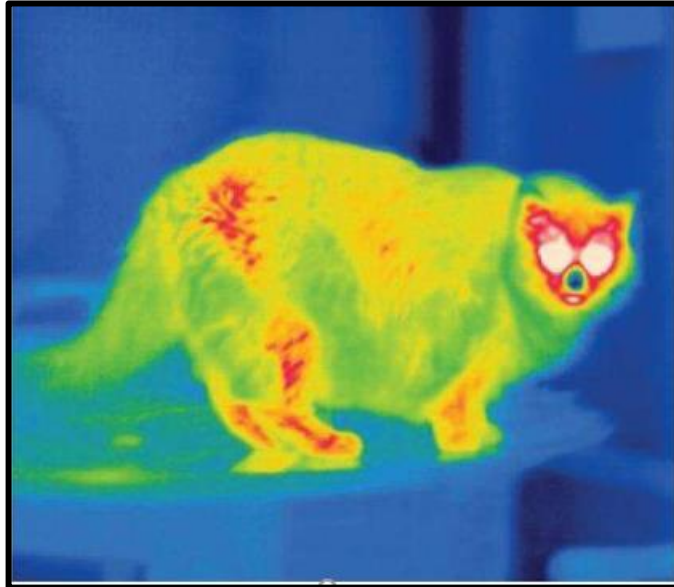
Figura 11 - Termograma em cores falsas mostra a taxa com a qual a energia é irradiada por um gato. O branco e o vermelho são cores?
