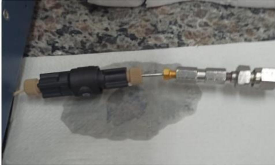
Figura B2. Restritor de fluxo com vazamento. Fonte: Autor.
