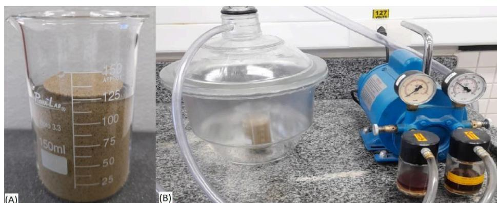
Figura 16. Equipamentos para realização dos processos de saturação: (a) Béquer com amostra de rocha; (b) Dessecador conectado a bomba a vácuo. Fonte: Autor.
