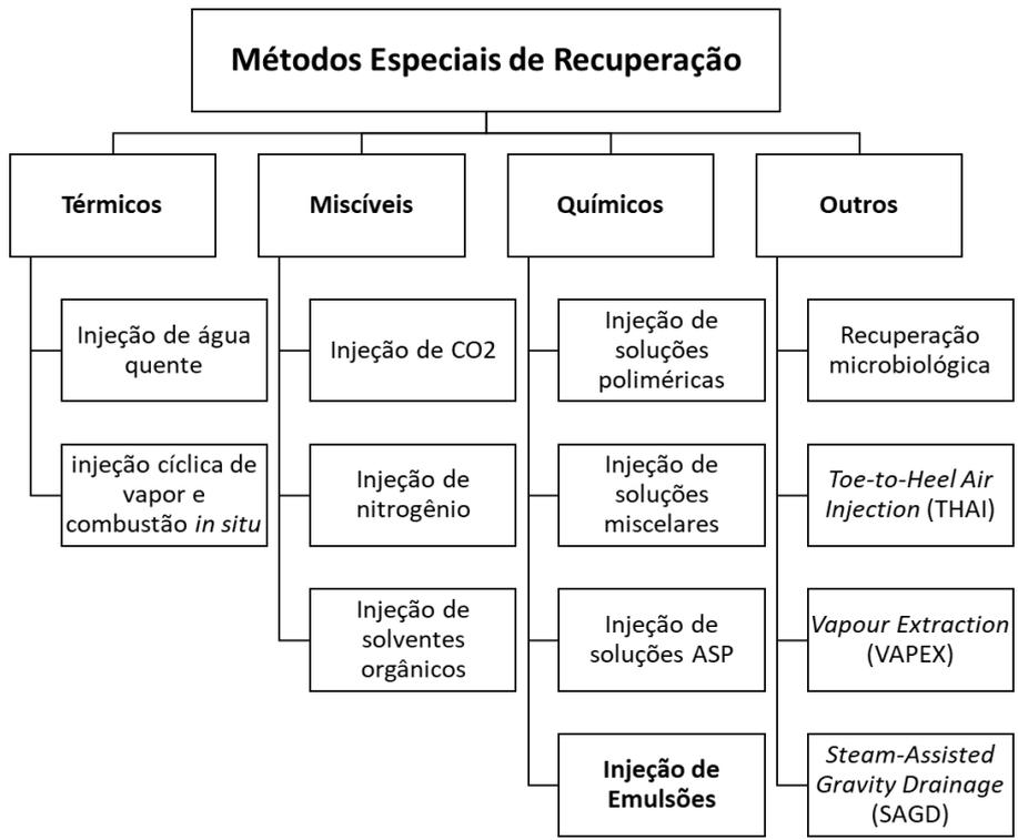
Figura 5. Classificação dos métodos especiais de recuperação. Fonte: Adaptado de Lake (1989).
