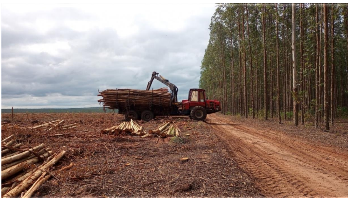
Figura 6 – Máquina de extração adotada na empresa florestal (Forwarder).
