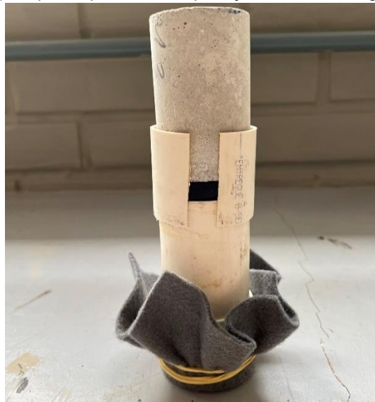
j) corpo de prova com aplicação da sobrecarga
