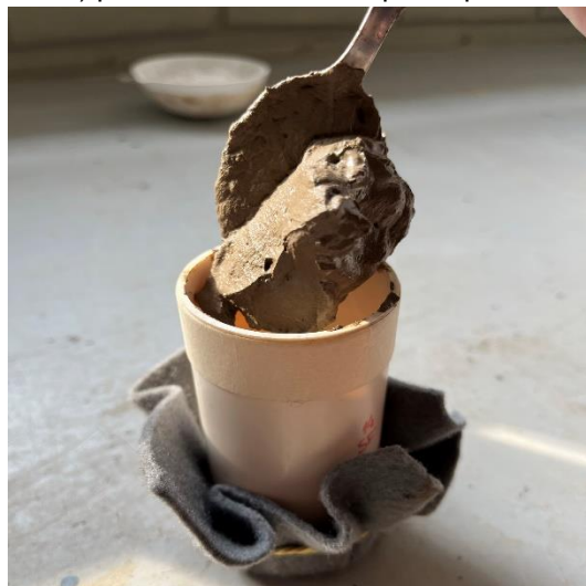
j) corpo de prova com aplicação da sobrecarga
