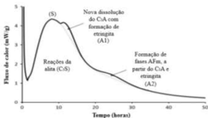
Figura 5 – Curva típica do fluxo de calor de um cimento formado por C_3S , C_3A e gipsita.
