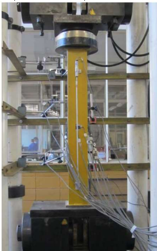
Figura 3.1 - Esquema do ensaio do pilar misto submetido à força axial
