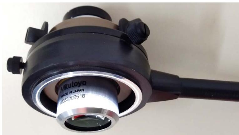
**Figura 5.14.** Ring LED Light A5351FA036 Techniquip, centralizador e lente objetiva Mitutoyo M Plan Apo 10X.
