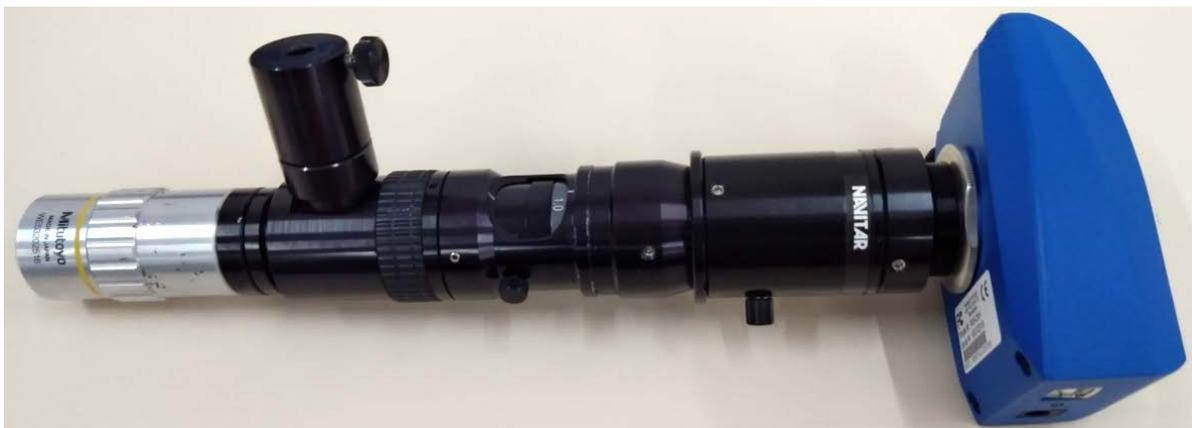
Figura 5.11. Sistema de aquisição de imagens por fotomicroscopia.
