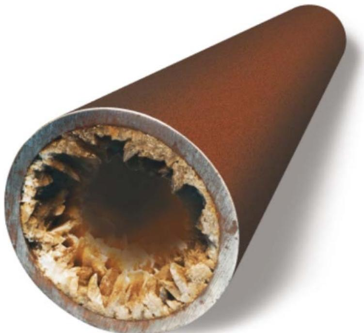
**Figura 1.1.** Incrustação de  $\text{CaCO}_3$  em uma coluna de produção de petróleo (Crabtree *et al.*, 1999).
