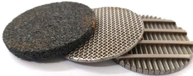
**Figura 5.30.** Conjunto de elementos sob análise, da esquerda para a direita (sentido do fluxo de fluido): sinterizado de 5 mm de espessura simulando o *gravel pack*, tela e suporte da tela (conjunto de telas *premium*).
