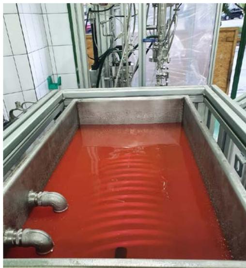
**Figura 5.24.** Tanque pulmão de água fria, com aproximadamente 45 litros de água e 2 litros de fluido de radiador. Nessa oportunidade, mesmo sem a tampa, alcançou 3 °C.
