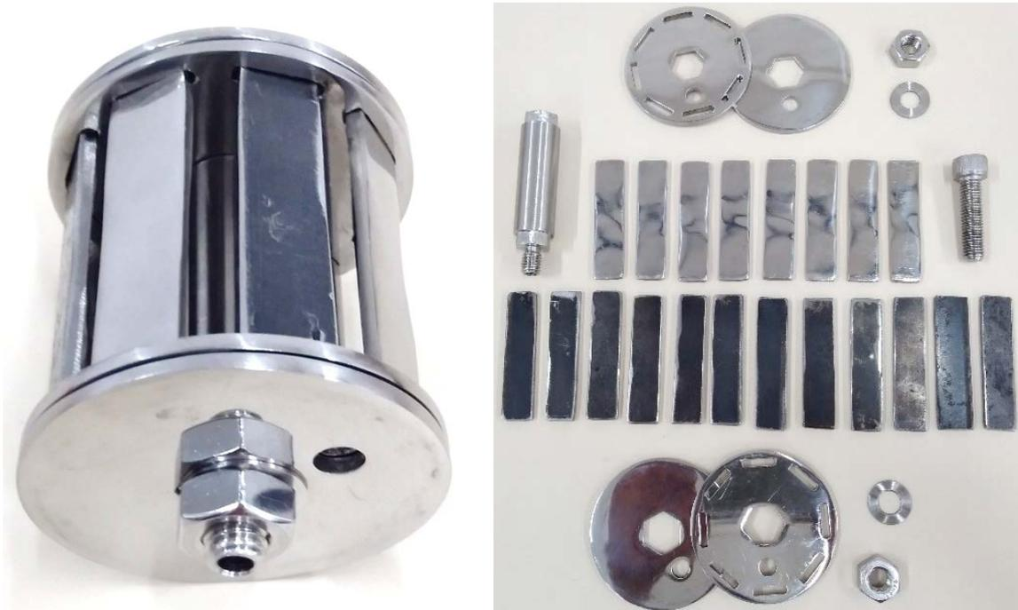
**Figura 5.4.** Gaiola de cupons com 4 elementos em aço 1020 e com 4 elementos em aço inox 316L (à esquerda) e o dispositivo desmontado junto com mais cupons para a identificação de suas partes (à direita).
