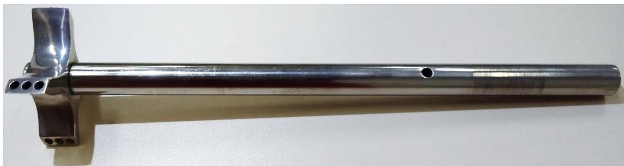
**Figura 5.3.** Impelidor auto-dispersor de gás com eixo oco.
