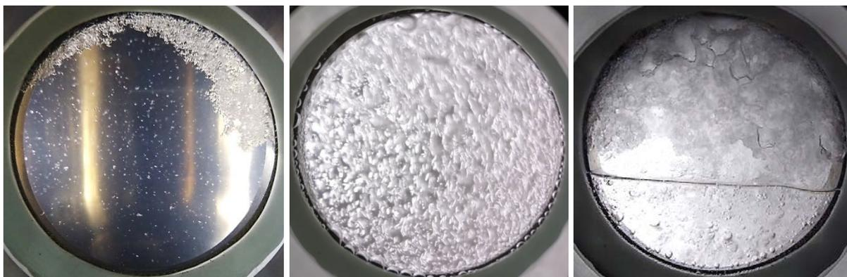
**Figura 5.34.** À esquerda, o início da formação de hidratos de  $\text{CO}_2$ . Ao centro, quando o sistema alcançou o equilíbrio a  $5\text{ }^\circ\text{C}$  e 60 bar. À direita, quando a pressão do sistema estava sendo aliviada.
