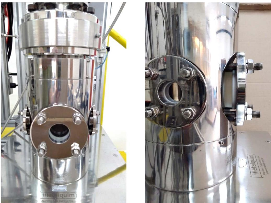
**Figura 5.5.** Imagem frontal da janela de  $\phi 56$  mm (esquerda) e de perfil ressaltando sua espessura de 29 mm (direita).
