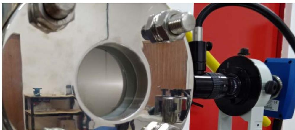
**Figura 5.18.** Técnica de iluminação incorporando uma fonte de luz no ocular do microscópio. Dentro do reator se vê a convergência do foco de luz correspondente à distância focal da lente objetiva.
