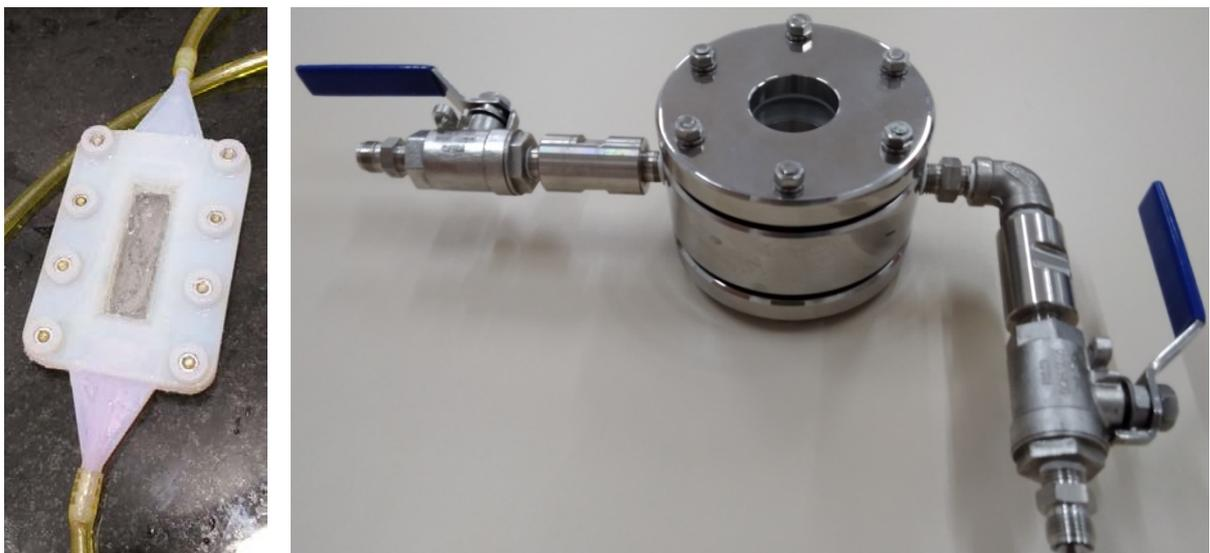
**Figura 5.20.** Protótipo do visor dinâmico construído com lâminas de microscopia e gabinete produzido em impressora 3D (esquerda) e o visor dinâmico para 100 bar e 100 °C (direita).
