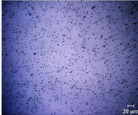
**Figura 5.39.** Pequenos cristais de barita ( $\text{BaSO}_4$ ) aderidos ao vidro da janela de visualização lateral quase que instantaneamente à injeção da água do mar no reator contendo uma solução de  $\text{BaCl}_2$ .
