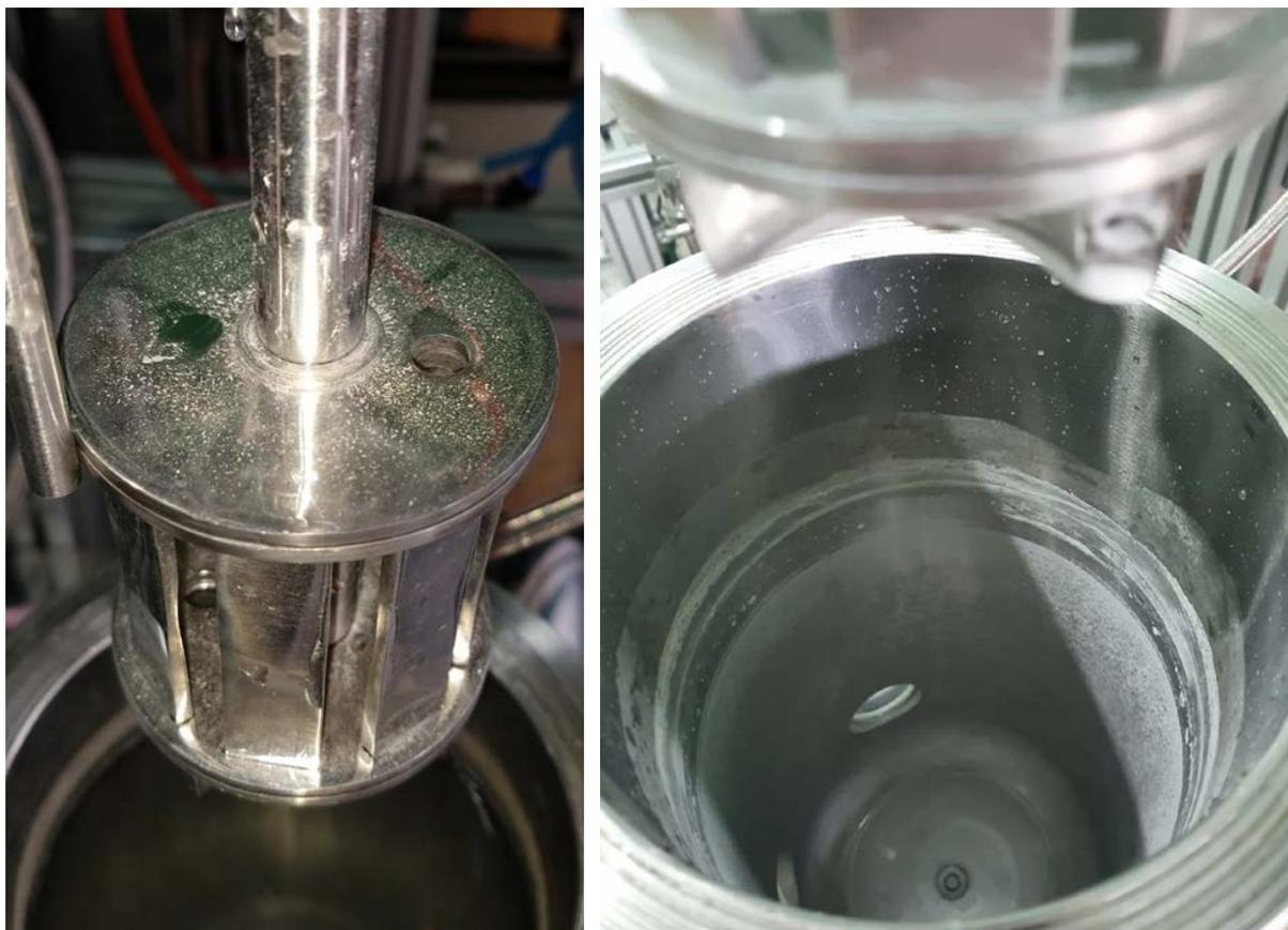
**Figura 5.27.** Situação final do eixo, da gaiola, dos cupons e do interior do reator bastante incrustados com carbonato de cálcio após o ensaio qualitativo.
