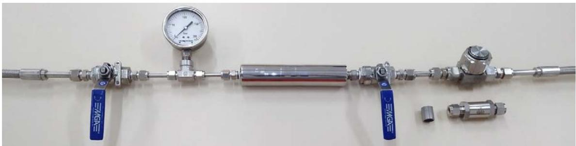
Figura 5.28. Nanofiltro com coletor de amostra para a medição indireta do  $\text{CaCO}_3$  precipitado.
