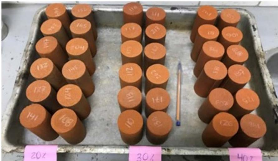
**Figura 5.64.** Núcleos artificiais ( $\phi 1,5''$ ) produzidos pela equipe do Laboratório de Geotecnia da UFES.
