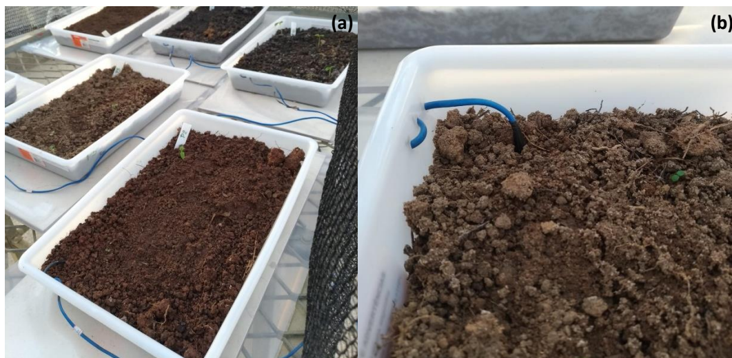
Figura 1.5 Distribuição dos sensores Type T Thermocouple (a) e detalhe da instalação (b) no banco de sementes do solo do remanescente de Floresta Estacional Semidecidual, Floresta Nacional de Pacotuba, ES, Brasil, em bancadas de metal preparadas para redução da radiação solar. Fonte: a autora.
