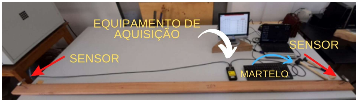
Figura 4 – Método stress wave utilizando o equipamento Fakopp
