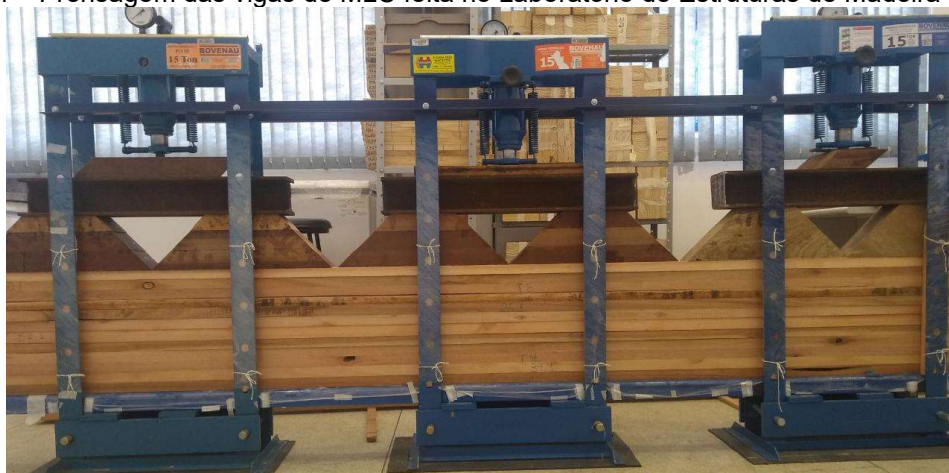
Figura 4 – Prensagem das vigas de MLC feita no Laboratório de Estruturas de Madeira da UFES.
