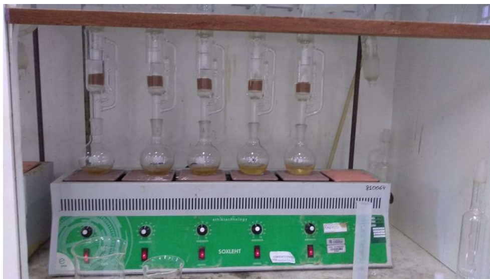
Figura 1 – Ensaio de teor de extrativos totais para madeira de eucalipto do clone de Eucalyptus urophylla × Eucalyptus grandis .
