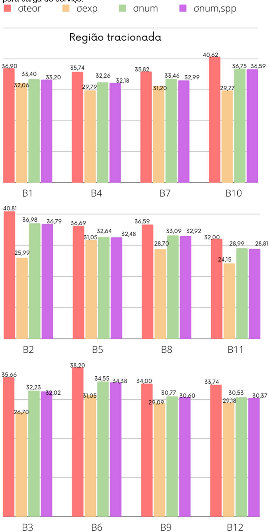
Figura 9 – Tensão de tração (teórica, experimental, numérica e numérica sem peso próprio) das vigas em MLC para carga de serviço.
