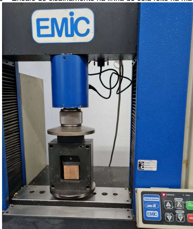
Figura 6 – Ensaio de cisalhamento na linha de cola feito na máquina universal da Emic.
