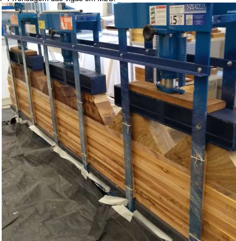
Figura 1 -Prrensagem das vigas em MLC.
