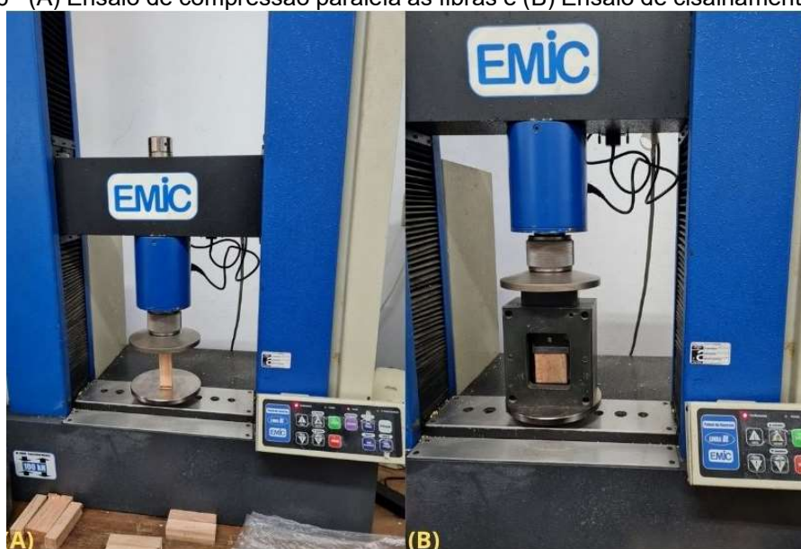
Figura 6– (A) Ensaio de compressão paralela às fibras e (B) Ensaio de cisalhamento paralelo às fibras.
