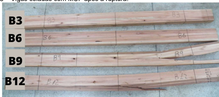
Figura 18 – Vigas coladas com MUF após a ruptura.
