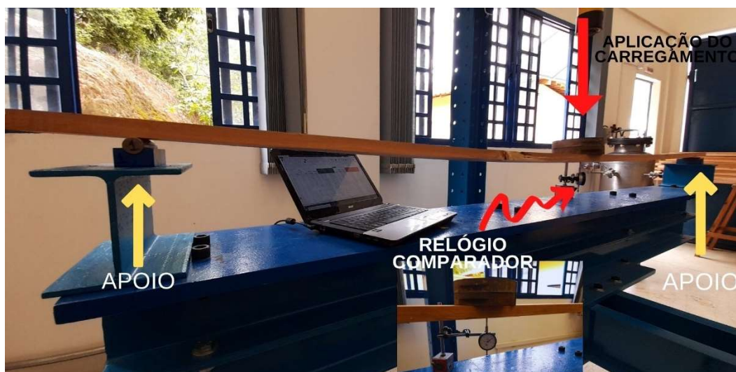
Figura 2 – Ensaio de resistência à flexão estática em 3 pontos.
