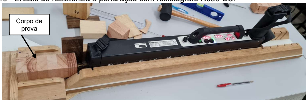
Figura 10 - Ensaio de resistência à perfuração com resistógrafo R650-SC.
