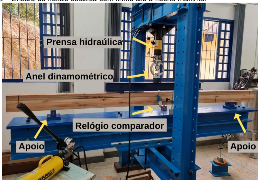
Figura 5 – Ensaio de flexão estática com limite até a flecha máxima.
