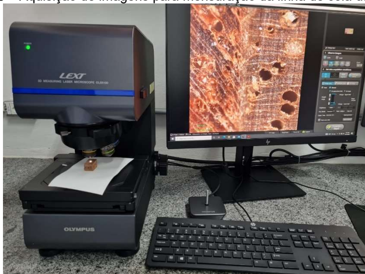
Figura 8 – Aquisição de imagens para mensuração da linha de cola utilizando o microscópio confocal.
