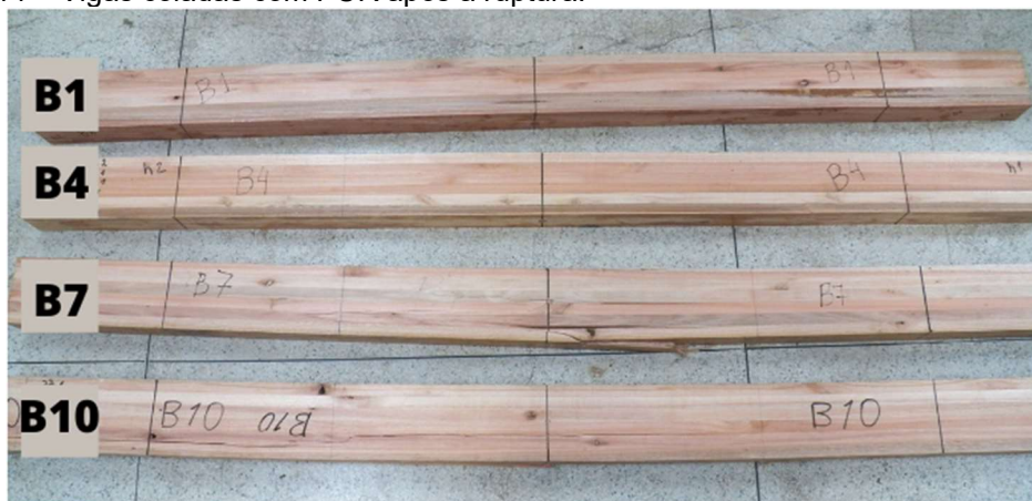
Figura 14 – Vigas coladas com PUR após a ruptura.
