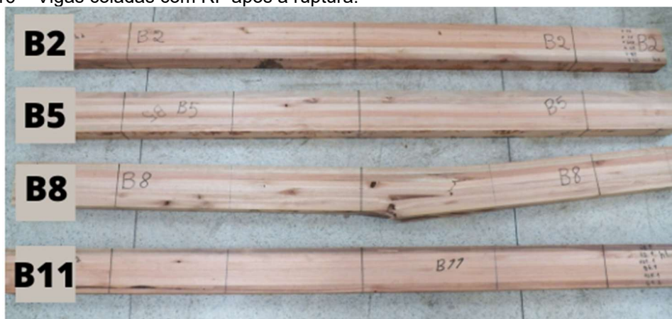
Figura 16 – Vigas coladas com RF após a ruptura.
