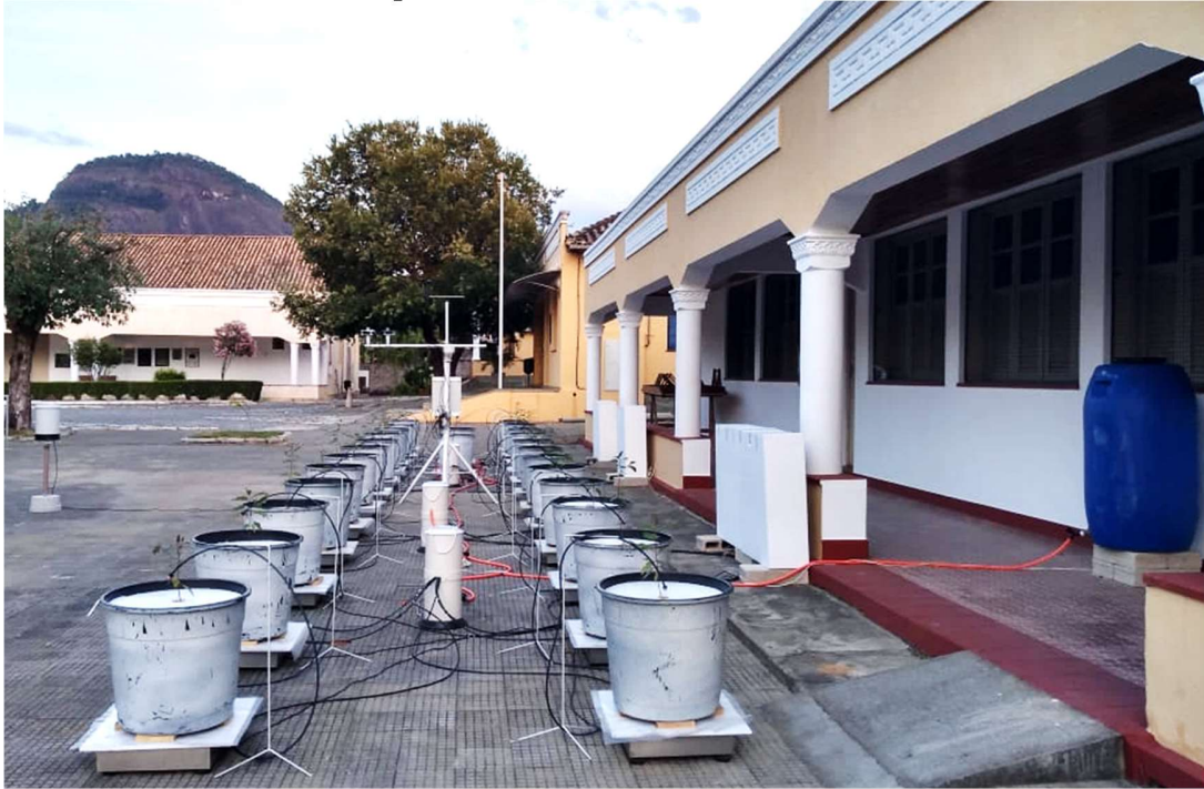
Figura 1.1 - Localização da área de estudo e distribuição dos vasos em lisímetros de pesagem eletrônica. Jerônimo Monteiro, Espírito Santo, Brasil.
