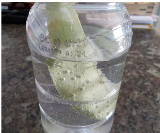
Figura 25 - Folha verde num pote com água e bicarbonato de sódio, após a incidência de luz solar.
