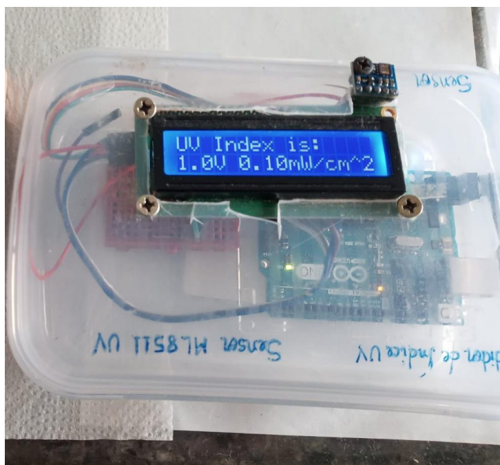
Figura 18 - Circuito Sensor UV com auxílio de microcontrolador Arduino.
