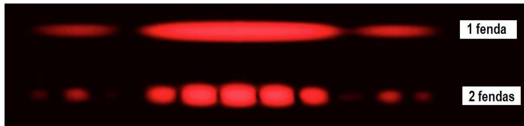
Figura 4 - Figuras de difração projetadas num anteparo por uma fenda única e por uma fenda dupla.
