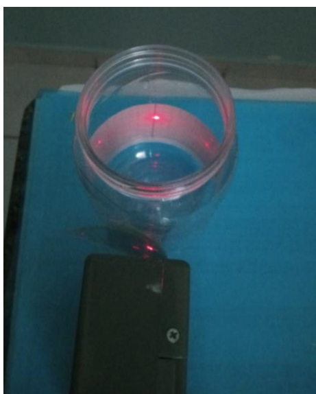
Figura 13 - Experimento para obtenção do índice de refração da água com o uso do conceito de difração da luz.
