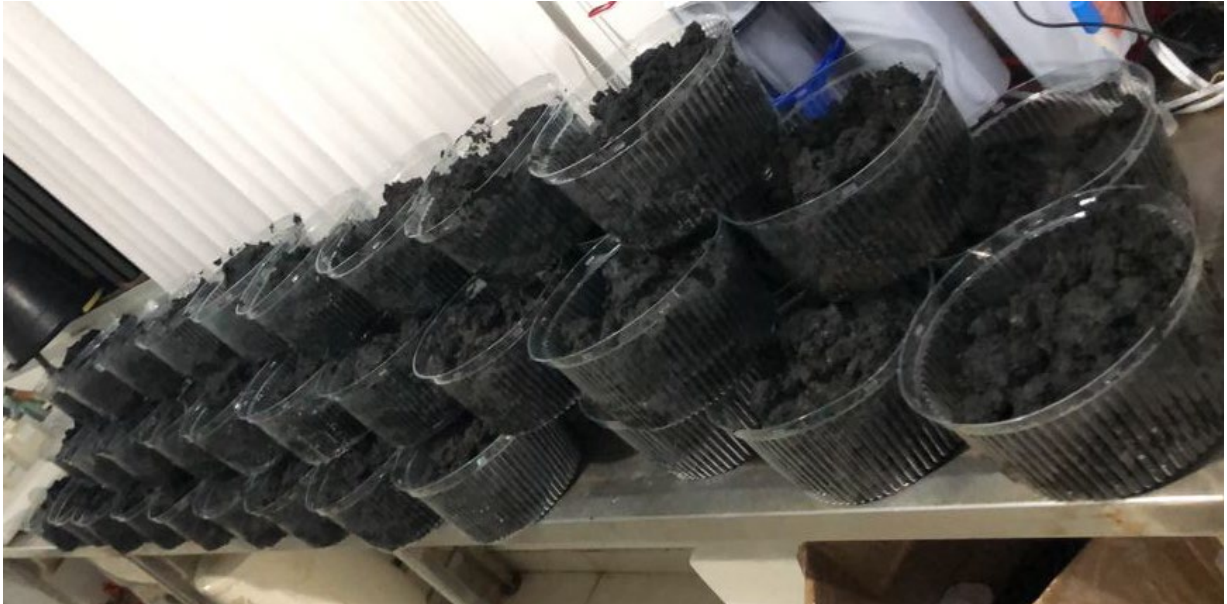
Figura 18 – Amostras de 2000 g de lodo a 70% de umidade previamente acondicionados.
