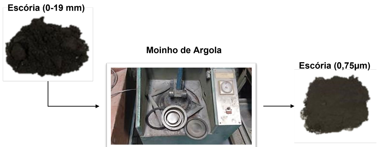
Figura 8 – Processo de redução das partículas de escória de aciaria (LD).
