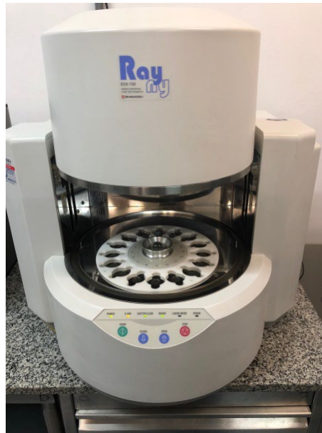
Figura 10 - Espectrômetro de fluorescência de raio-x Shimadzo modelo Ray Ny EDX-720.
