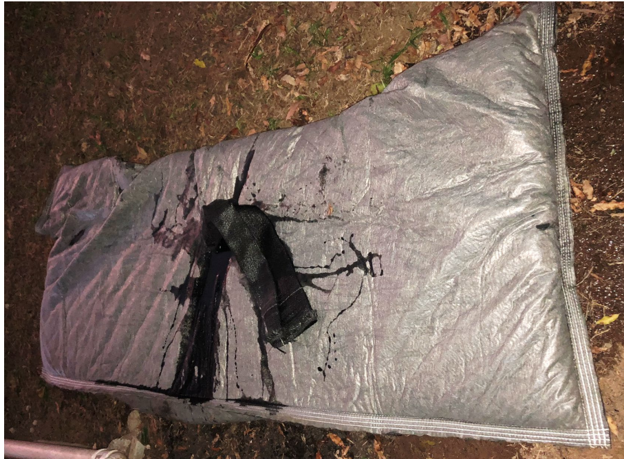
Figura 16 – Desaguamento do lodo em uma bolsa drenante BIDIM RT-31.
