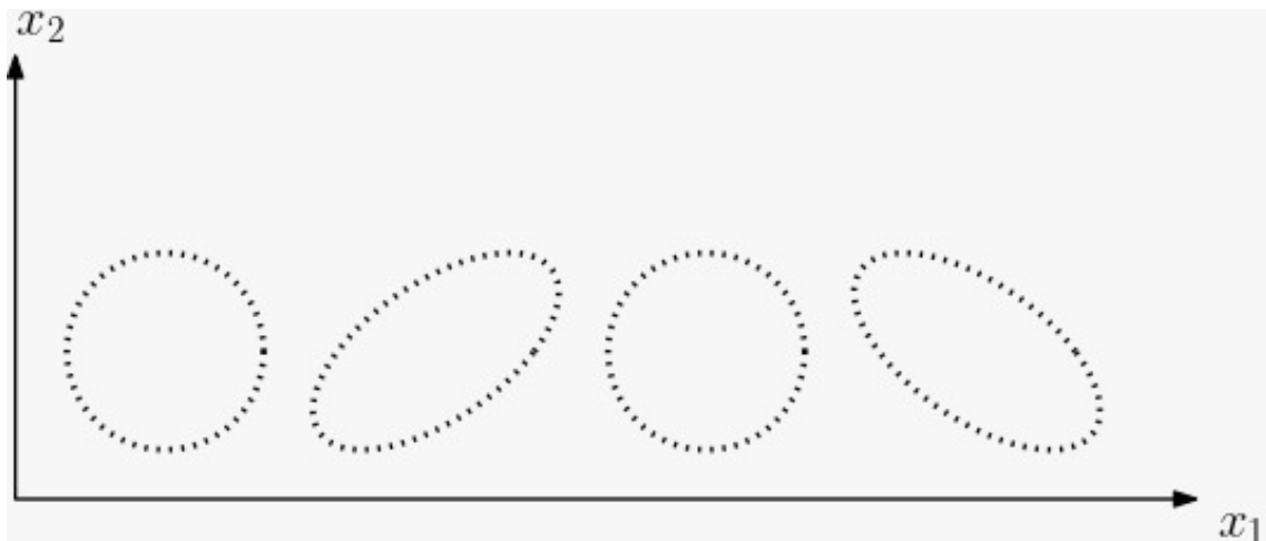
Figura 2 – O efeito de ondas gravitacionais em um anel de massas testes para o estado de polarização h_x .
