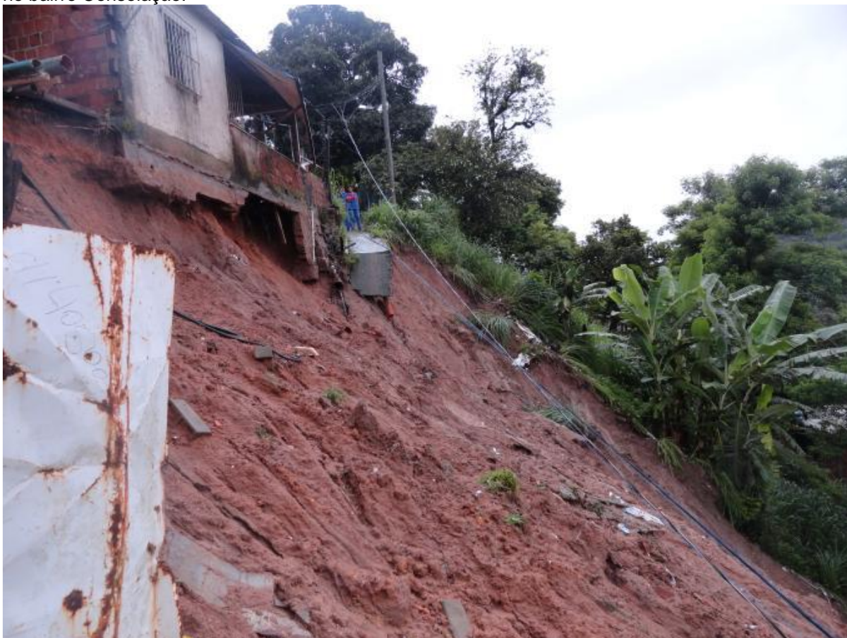
Figura 81 – Vista da cicatriz do escorregamento registrado no laudo geológico-geotécnico 127/2013, no bairro Consolação.
