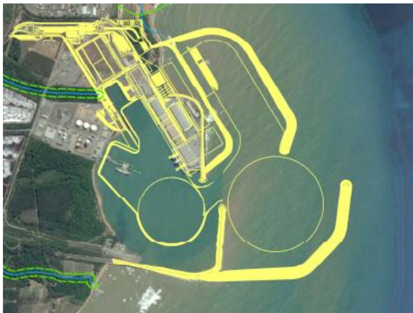
Figura 21: Em amarelo as estruturas projetadas para o Portocel II sobrepostas a imagem de satélite. Fonte: EIA (PORTOCEL, 2017, p.46).
