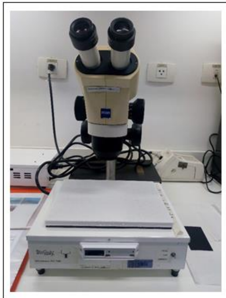
Figura 21 - Fotografia de estereoscópio (lupa) acoplado a mesa fria utilizado para a identificação de mosquitos criopreservados.
