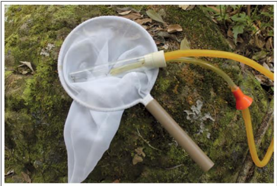
Figura 18- Fotografia de Puçá entomológico e capturador de sucção oral (capturador de Castro) utilizados na coleta de mosquitos adultos. Fonte: (BRASIL, 2017c).
