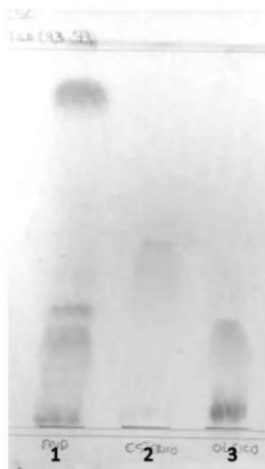
Figura 2: Placa revelada de cromatografia em camada delgada para óleo de andiroba. Padrões e amostra para ácidos graxos: andiroba (A), esteárico (B), oleico (C). Fonte: Acervo pessoal (2021).
