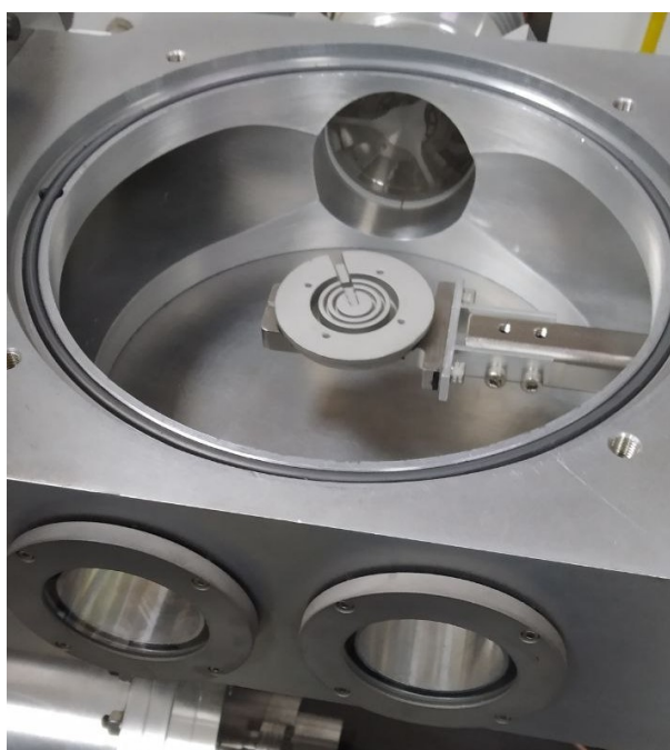
Figura 11 – Antecâmara aberta. Nela podemos ver este "braço" com um porta-amostra, onde a amostra está virada para baixo.
