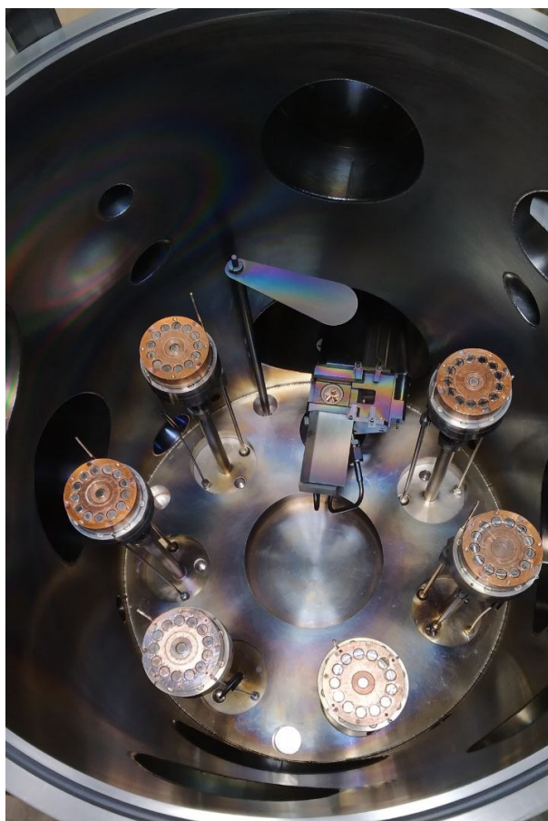
Figura 7 – Câmara principal onde ocorre o processo de deposição com 6 fontes magnetron sputtering numa configuração de ímãs capaz de aprisionar o plasma em baixas pressões.
