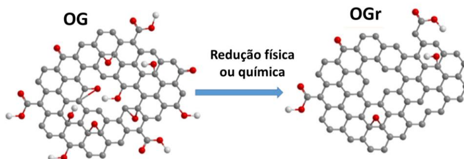
Figura 17: Modelo de redução de parte das frações oxigenadas do OG para obtenção de OGr. Figura adaptada. 91
