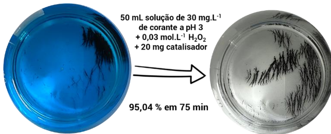
Figura 34. Ilustração real do processo do início ao fim da descoloração do corante azul de metileno nas condições experimentais utilizadas no trabalho
