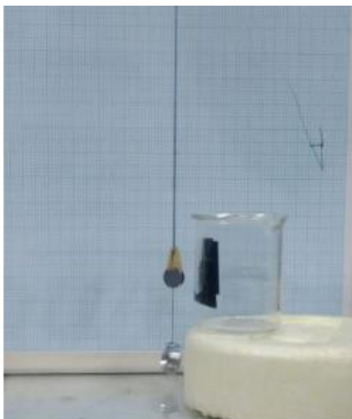
Figura 25 Dispositivo para verificar o sinal supercondutor das amostras sinterizadas. A amostra fica imersa em nitrogênio líquido e é colocada perto de um ímã pendurado por um cabo leve. Se a amostra for supercondutora, ela expulsa do seu interior o campo magnético, assim o ímã é repelido e o pêndulo sofre um deslocamento, saindo da sua posição de repouso. Com uma escala de fundo e um segundo pêndulo de referência que permanece sempre na vertical, é possível medir o ângulo de deslocamento e calcular a força de repulsão.
