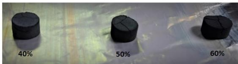
Figura 33 Amostras de compósitos (100-x) AISI 316L + x Sm-123 (x = 40, 50 e 60%, em massa) produzidas através da rota 3 de sinterização apresentando muitas trincas.
