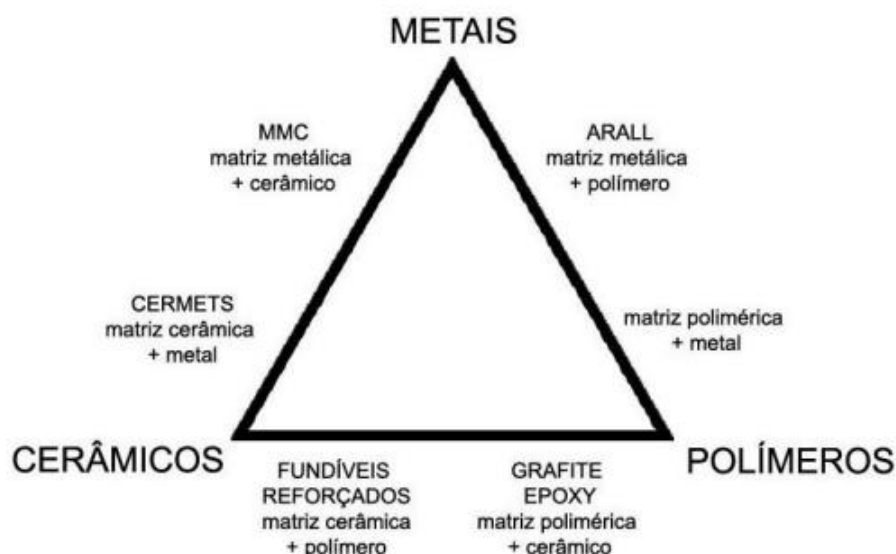
Figura 12 Representação esquemática correlacionando o tipo de material utilizado para produção do compósito com o tipo de compósito produzido. Os vértices do triângulo simboliza 100% do material.
