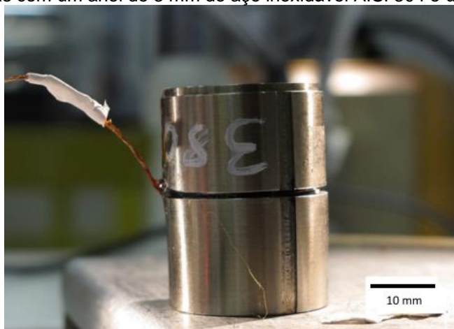
Figura 23 Compósito supercondutor estrutural composto por duas amostras de cerâmica de Gg-123 reforçadas com um anel de 3 mm de aço inoxidável AISI 304 e unidas por resina epóxi.
