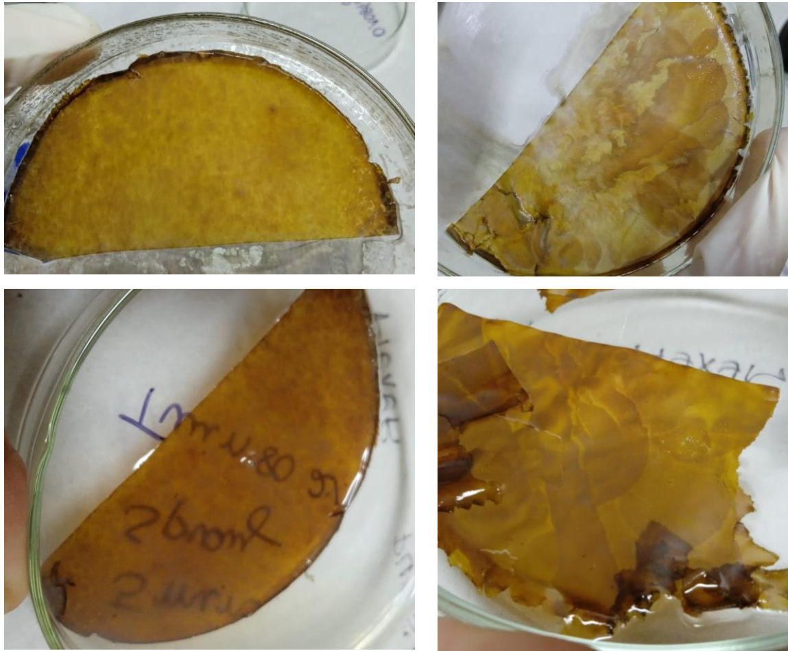
Figura 22: Aspectos macroscópicos do material obtido a partir da funcionalização de nanocelulose com nanopartícula de prata (antes da lavagem e secagem)
