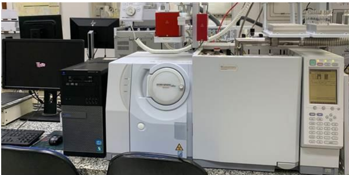
Figura 8 – Cromatógrafo gasoso acoplado a Espectrômetro de Massas (CG-EM). Modelo GC 2010 Plus/GCMS - QP2010, Shimadzu, Kyoto, Japan.
