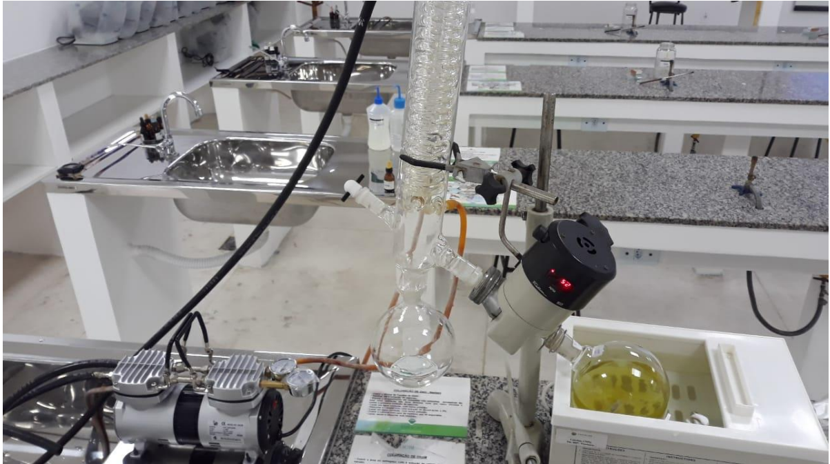
Figura 5 – Secagem das amostras por meio do uso de Evaporador rotativo (Fisatom® 802) acoplado a bomba de vácuo (GS® VAC30) e banho-maria (Fanem® 1102).
