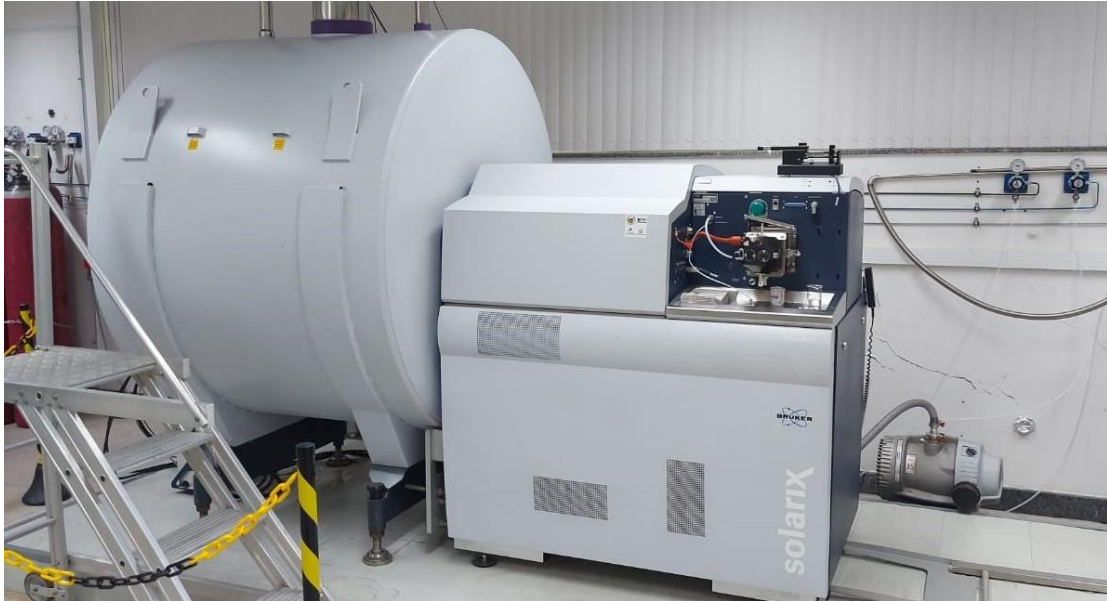
Figura 9 - Espectrômetro de Massas de Ressonância Ciclotrônica de Íons com Transformada de Fourier (ESI (-) FT - ICR MS). Modelo 9.4 T Solarix, Bruker Daltonics, Bremen, Alemanha.
