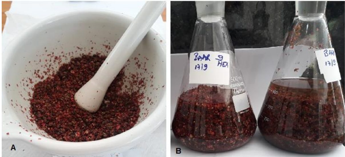
Figura 4 – Amostra de frutos de aroeira, clone BAAR 8, triturados com grau e pistilo de porcelana (A). Extração por meio do uso de solvente hexano em duas amostras de frutos de aroeira (B).
