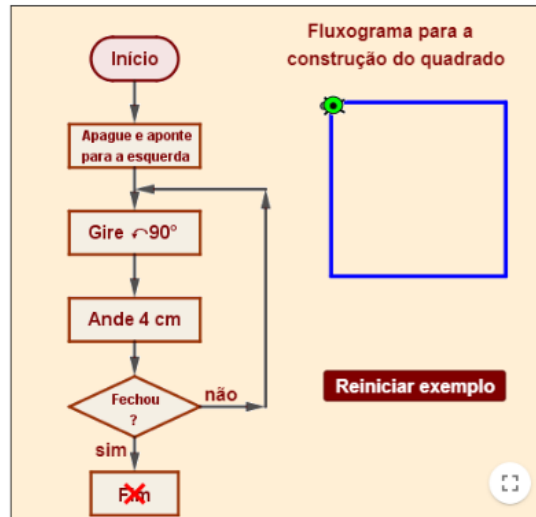
Figura 20 - Fluxograma construção de um quadrado
