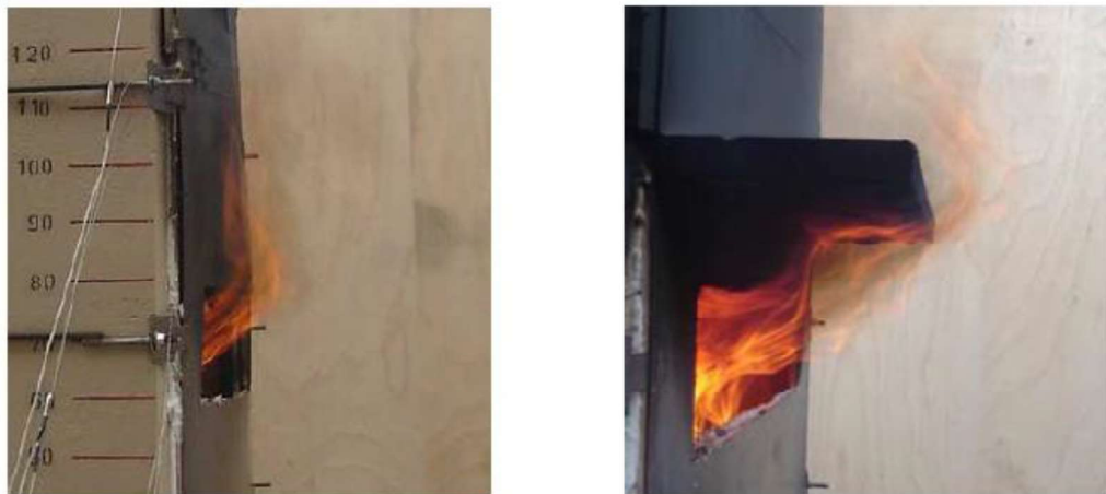
Figura 21: Ensaio sem e com projeção horizontal mostrando o “rebaixamento” das chamas ejetadas pela janela com configuração larga. (Fonte: Rodrigues (2019))
