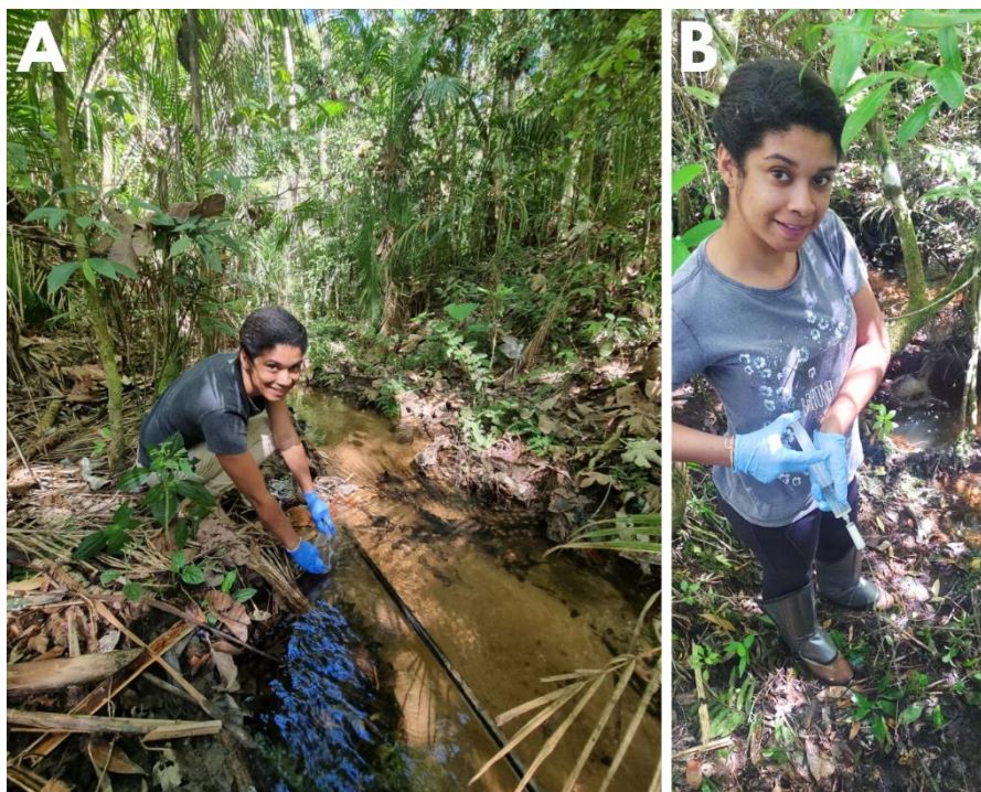
Figura 5. Processo de filtração de água em campo. A- coleta da água do córrego com saco stand up; B- após a coleta da água a seringa a água é filtrada manualmente, com o auxílio de uma seringa Sterivex.
