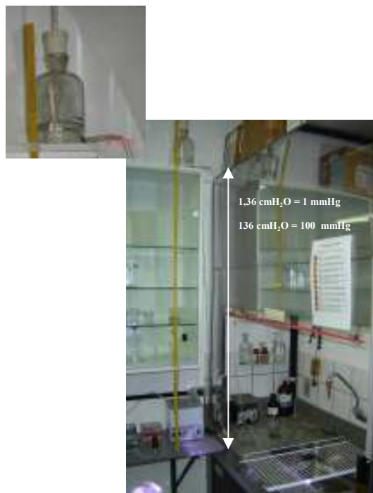
Figura 6: Sistema de perfusão sob pressão controlada de acordo com a variação da altura da coluna hidrostática (1,36 cm H 2 O = 1 mmHg). No alto vemos em maior detalhe o frasco de Mariotti.
