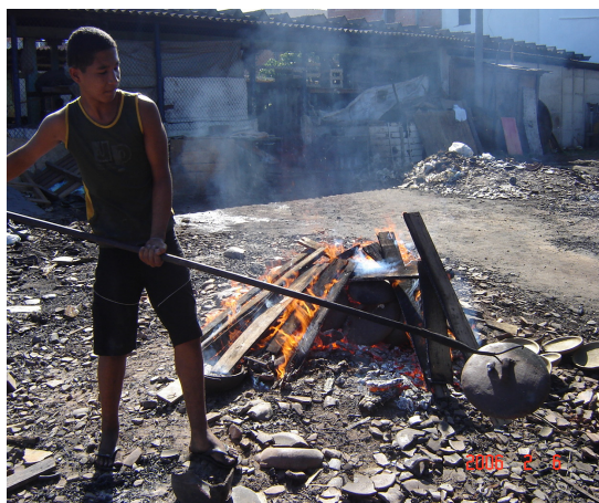
FOTO 33: RETIRADA DAS PEÇAS DA FOGUEIRA
