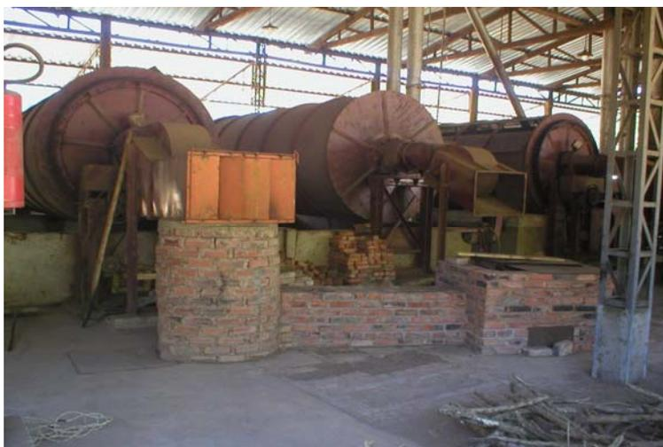
Figura 3.2: Forno pulsante horizontal para secagem de café - vista lateral
