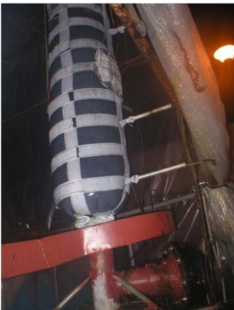
Figura 2.3: Combustor pulsante tipo tubo de Rijke com alto-falante na extremidade.
