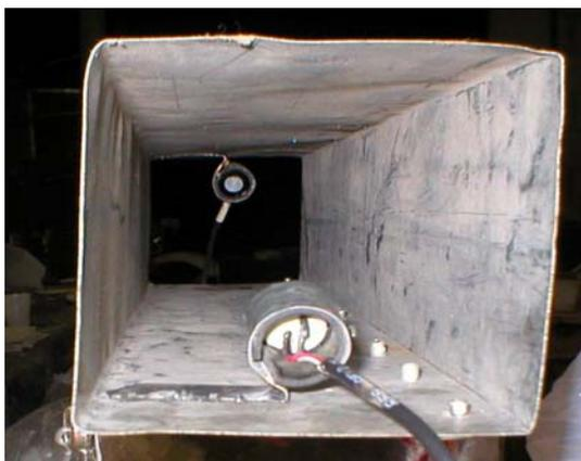
Figura 4.5: Sensor de velocidade do ar de combustão com emissor e receptor de ultra-som piezo elétrico.
