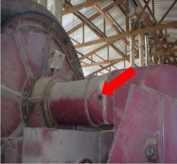
Figura 3.10: Medida da temperatura e vazão do ar de secagem
