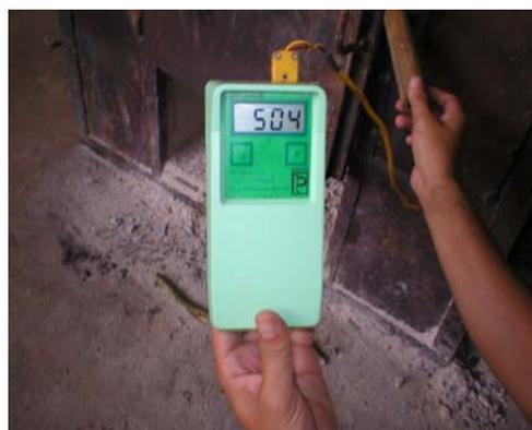
Figura 3.8: Medida de temperatura com termopar tipo K
