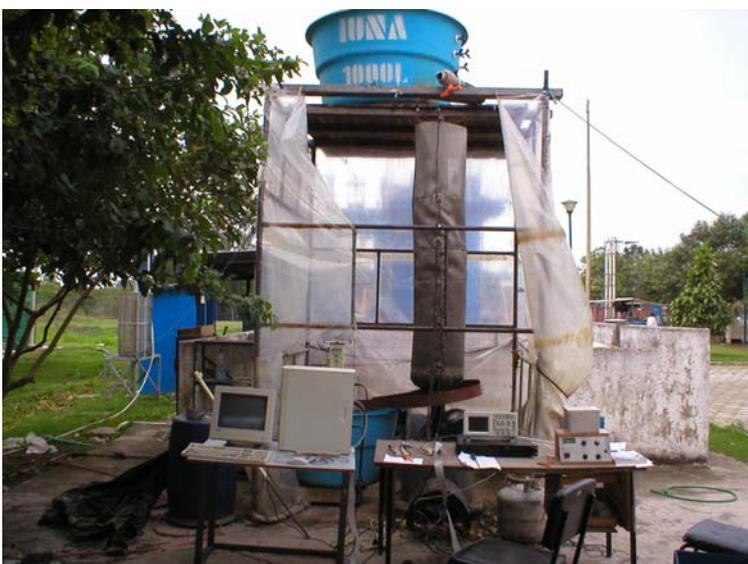
Figura 3.13: Montagem do sistema de secagem de lodo com forno pulsante
