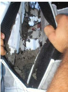
Figuras 3.22, 3.23 e 3.24: Derretimento da tela e secagem de lodo em tempo recorde na presença de pulsações
