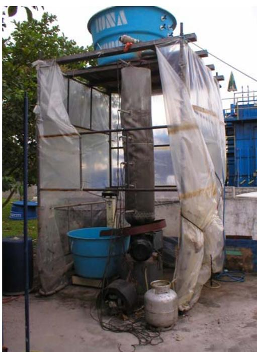
Figura 4.8: Configuração final do forno pulsante com sensores de pressão, temperatura, ventilador e alto-falante posicionados
