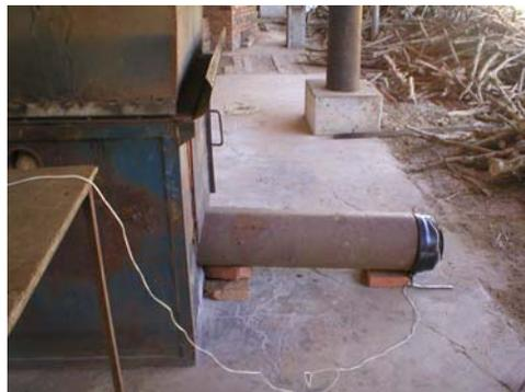
Figuras 3.3 e 3.4: Adaptação para pulsar a fornalha
