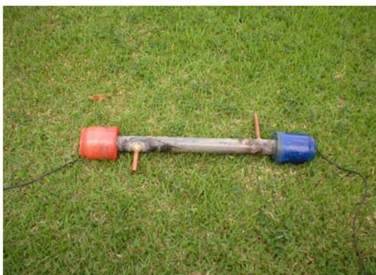
Figura 4.4: Sensor de velocidade com emissor (vermelho) e receptor (azul) de ultra-som usado para medir vazão de GLP
