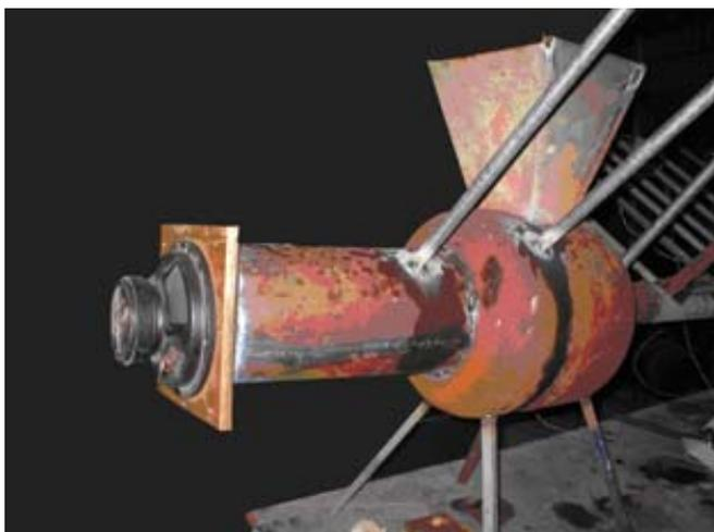
Figura 2.4: Alto-falante longitudinal - tomada de pressão e temperatura.
