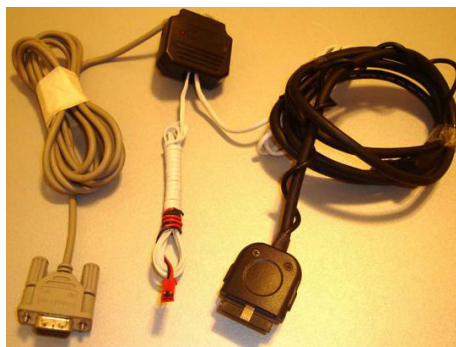
Figura 48 – Cabo de conexão entre PDA e mini-itx
