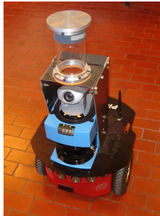
Figura 50 – Pioneer 3DX, da Mobile Robots (antiga ActivMedia ).
