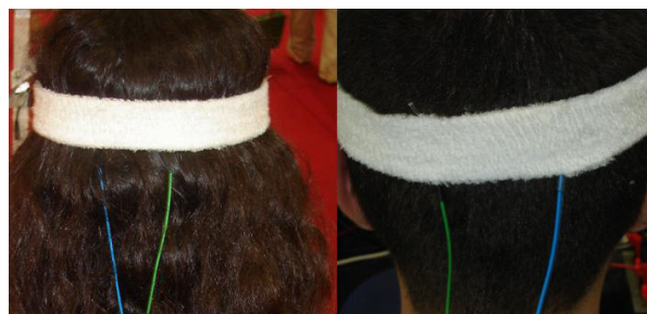
Figura 30 – Eletrodos individuais para captação de sinais EEG.
