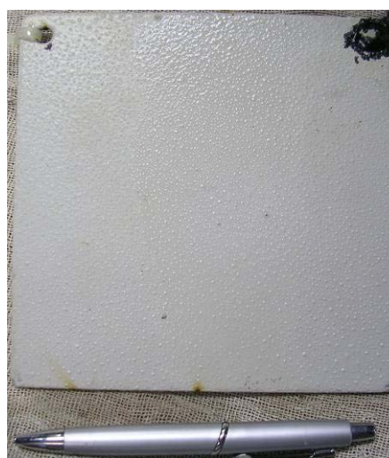
Figura 77 – Aspecto visual dos corpos de prova com películas alquídicas sobre substrato jateado com escória de aciaria (à esquerda) e cobre
