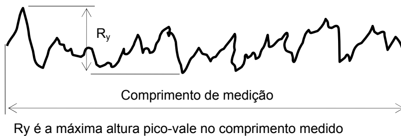
Figura 11 – Máxima altura pico-vale em uma superfície ( R_y )
