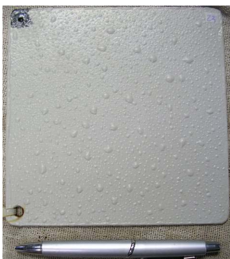
Figura 77 – Aspecto visual dos corpos de prova com películas alquídicas sobre substrato jateado com escória de aciaria (à esquerda) e cobre
