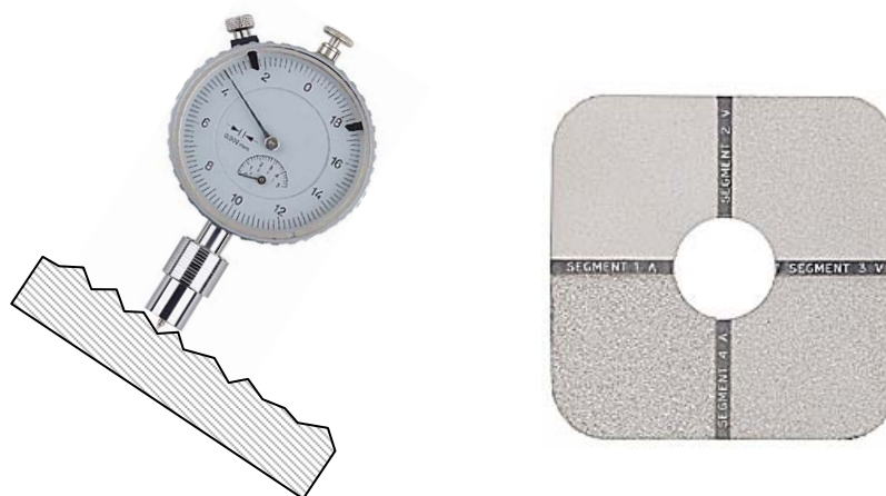
Figura 10 – Relógio apalpador para medição de altura pico-vale e padrão comparativo de rugosidade (à direita).
