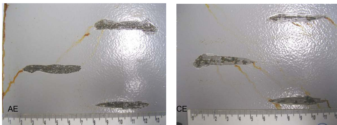
Figura 83 – Aspecto visual dos corpos de prova com películas epóxi sobre substrato jateado com escória de aciaria (à esquerda) e cobre
