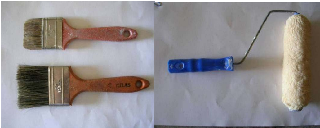
Figura 28 – Trincha e rolo empregados em pintura manual
