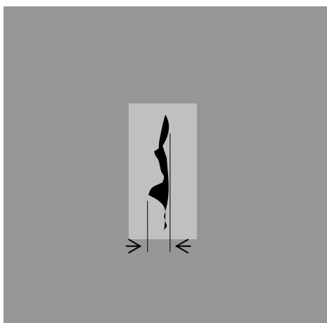
Figura 48 – Avanço de corrosão a partir de riscos artificiais
