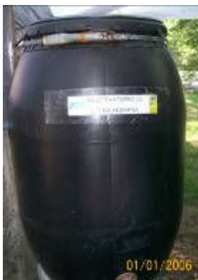
Figura 4.3 – Modelo do reservatório de 250L utilizado para a estocagem de Águas Amarelas.
