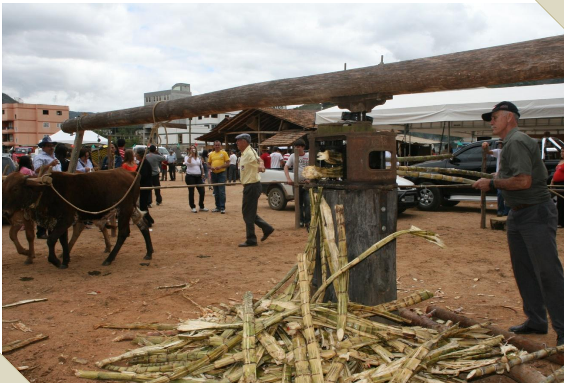
Foto 16: Paiol do nonno : engenho de cana tocado a boi
