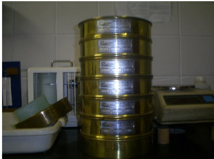
Figura 4.13: Peneiras manuais utilizadas para peneiramento de amostras de AGRECV-ES
