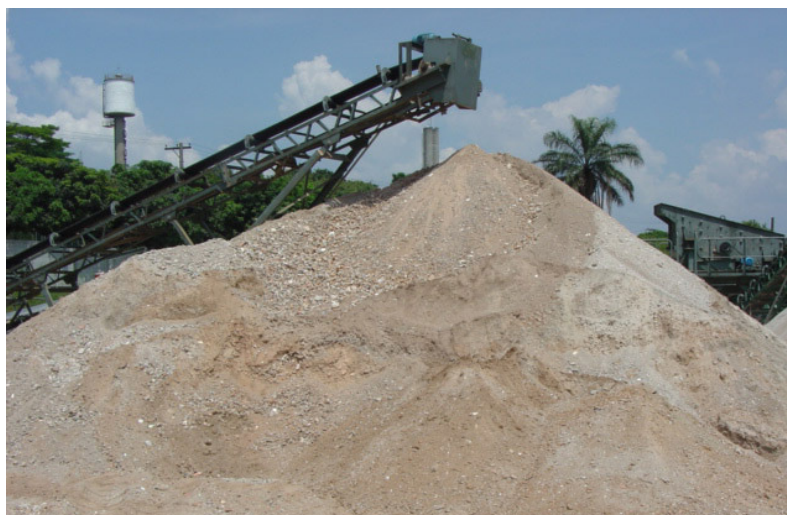
Figura 3.11: Pilha de RCC's de Classe A beneficiados Fonte: arquivo técnico da empresa Marca Ambiental
