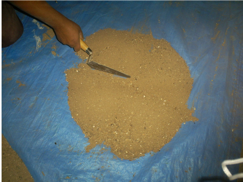
Figura 4.15: Quarteamento manual desenvolvido com colher de pedreiro
