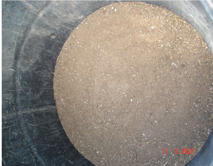
Figura 4.11: Grupo “1.solo e areia” – material passante na peneira 4,75 mm
