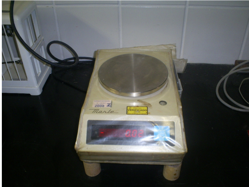
Figura 4.16: Balança eletrônica de precisão com capacidade de 1kg
