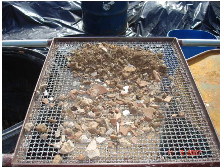
Figura 4.9: Material retido no primeiro peneiramento de uma amostra de ENTUV-ES
