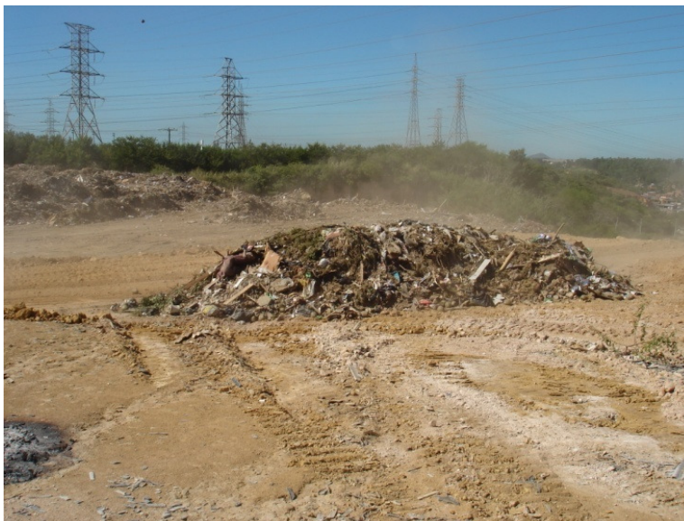
Figura 4.1: Pilha de ENTUV-ES escolhida para coleta de amostras
