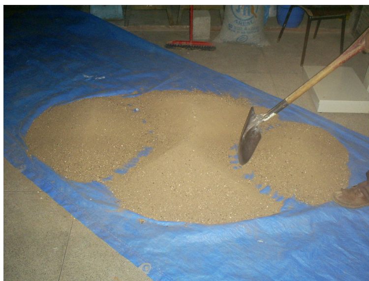
Figura 4.14: Quarteamento manual realizado com pá
