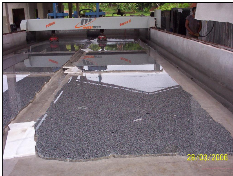
Fig. 3.7. – Polimento de chapas de granito
