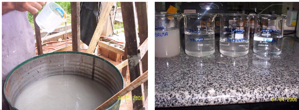
Fig. 4.12 – Adição do polímero à lama e amostras do filtrado coletadas em diversos espaços de tempo.
