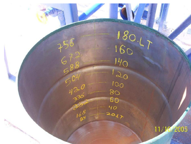
Fig. 4.4. – Tambor graduado para medir a vazão no decantador pelo método volumétrico.
