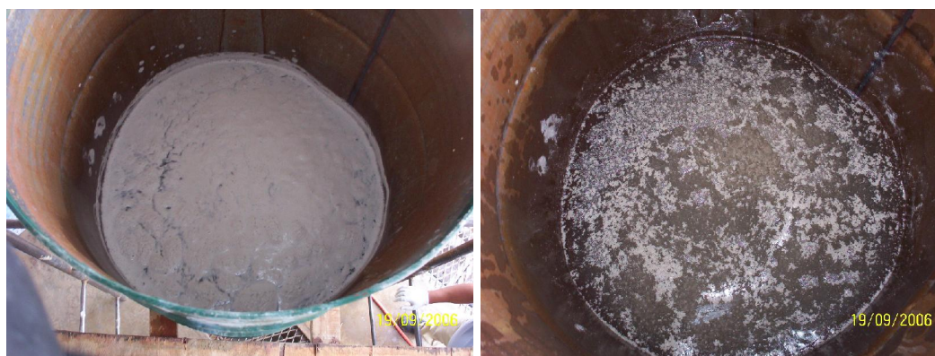
Fig. 5.12. – Mistura de 60% lama polimento e 40% lama serragem antes e depois da flocculação com a adição de polímero.
