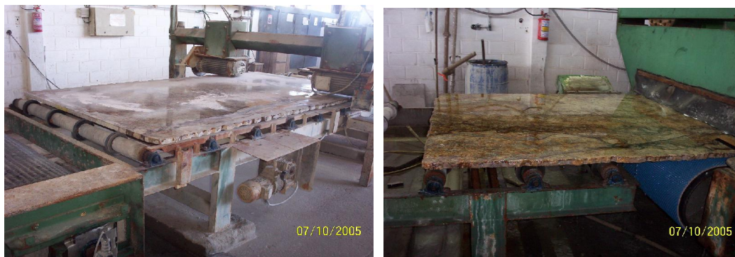
Fig. 4.5. – Chapa resinada e saída do segundo polimento.
