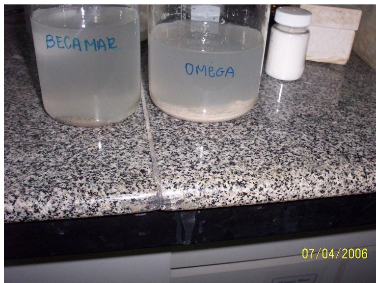
Fig. 4.9. Flocculação e sedimentação das amostras da lama do polimento com LT 30.
