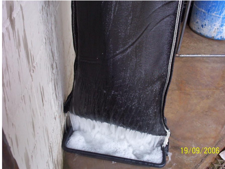
Fig. 5.14. Aspecto do líquido filtrado no início do teste da bolsa de pendurar.
