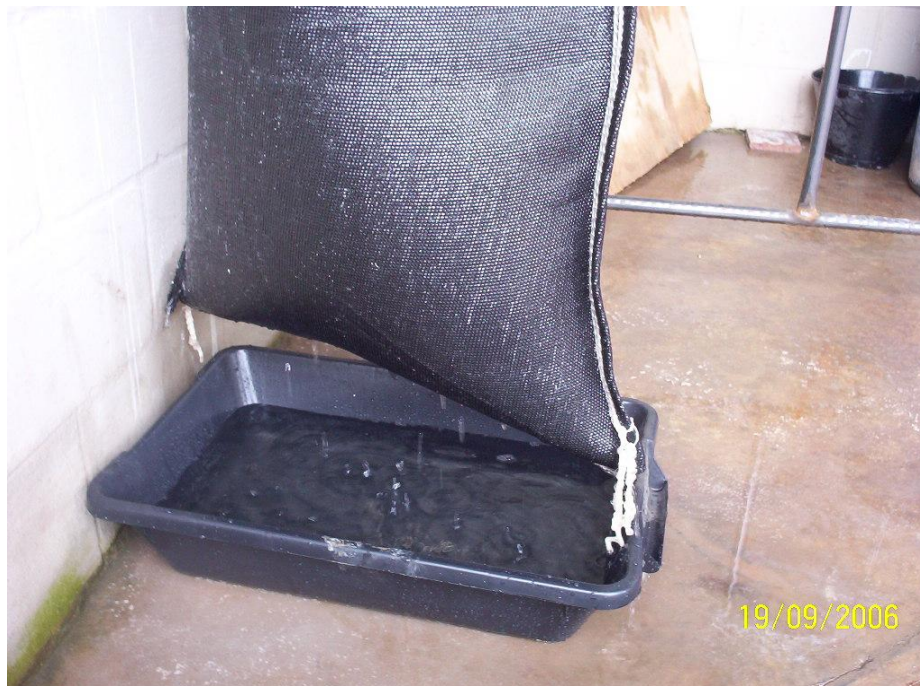
Fig. 5.15. Final do teste da bolsa de pendurar: aspecto do líquido filtrado.
