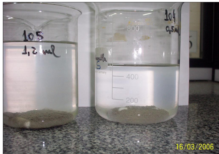
Fig. 4.7. Floculação das amostras de lama de polimento com IFLOC 104 e 105.
