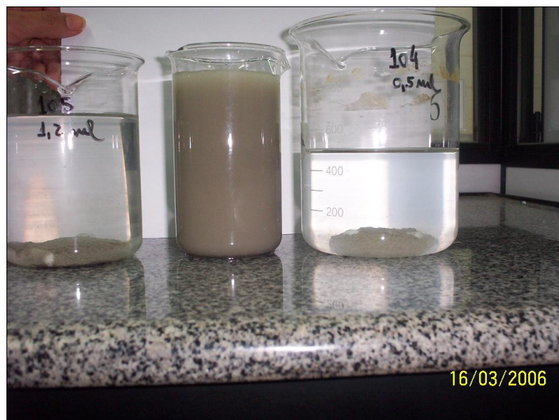
Fig. 4.8. Comparação da lama bruta do polimento com as amostras após adição dos polímeros.
