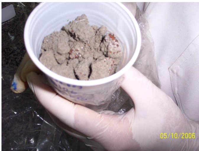
Fig. 4.13. – Sólidos retidos da mistura 80% polimento – 20% serragem.
