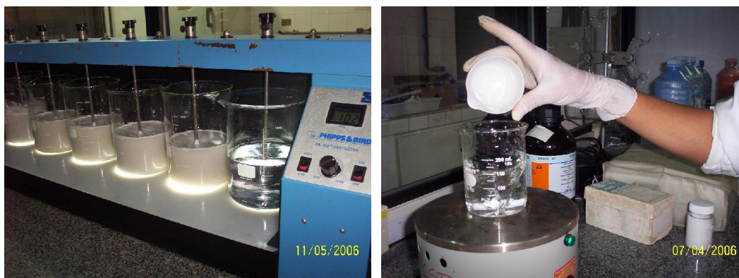
Fig. 4.6. – “Jar Test” dos efluentes e preparação do polímero.
