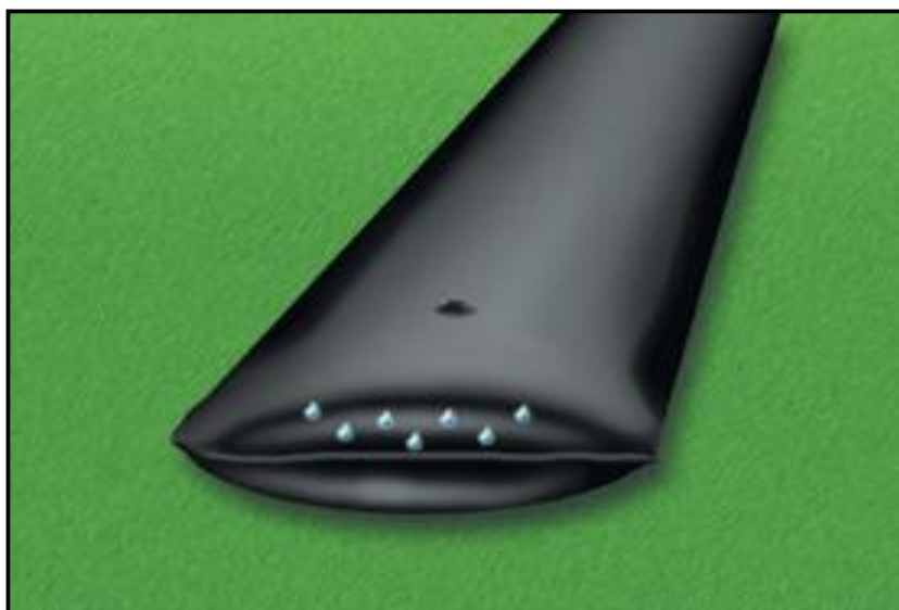
Fig. 3.21 – Segunda fase: Desaguamento ou desidratação. Fonte: Allonda.
