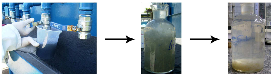
Figura 4.4: Análise de sulfeto dissolvido segundo os métodos 4500 – B e 4500 – F (APHA, 1995).
