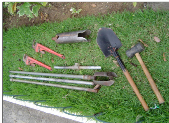
Figura 4-6: Material usado para abertura de um furo de amostragem a trado manual
