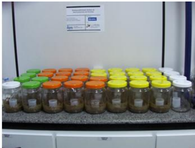
Figura 7 – Experimento respirométrico aeróbio composto de vermiculita e areia, meio mínimo, inóculo bacteriano e hidrocarbonetos derivados do petróleo.
