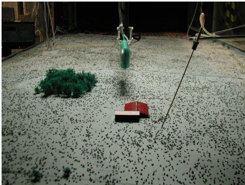
Figura 4-5: Experimento em túnel de vento realizado por Aubrun, Leiti e Schatzmann (CEDVAL, 2006).
