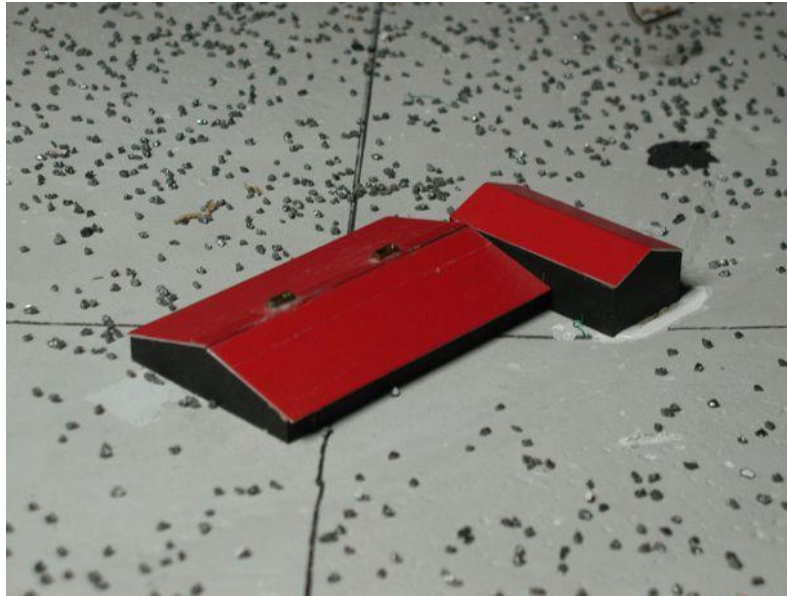
Figura 4-6: detalhe do modelo do prédio utilizado nos experimentos em túnel de vento (CEDVAL, 2006).
