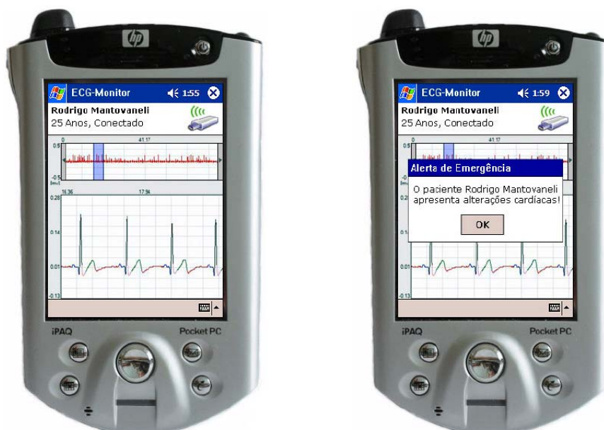
Figura 2-20 – a) Exemplo de monitoramento remoto; b) Exemplo de geração de alarmes.
