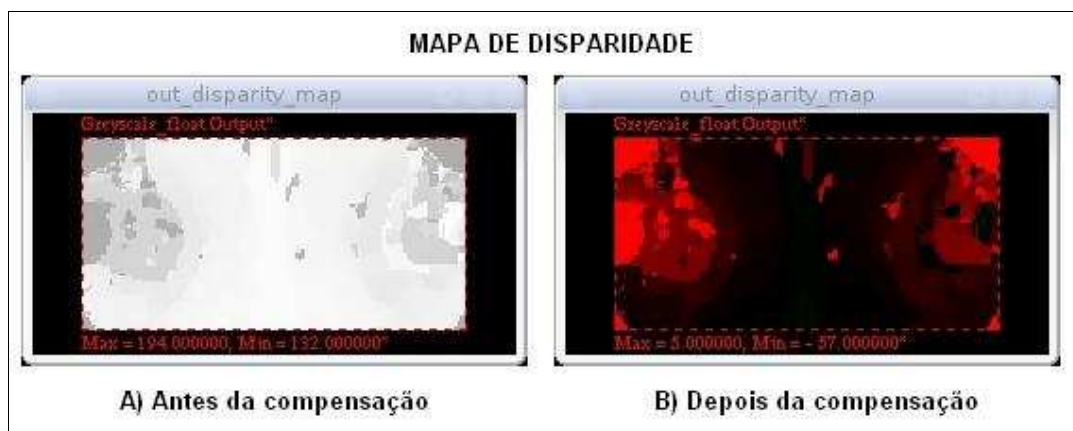
Figura 4-8 – Figura mostrando a compensação feita no mapa de disparidade após a vergência. (A) Antes da vergência, o mapa possui as disparidades associadas as coordenadas de cada uma das 64 camadas de MT, que neste caso variam de 132 à 194. (B) A vergência (neste caso) foi escolhida pela camada de coordenada 189, portanto, todo o mapa foi compensado, subtraindo a coordenada de vergência, onde a disparidade deve ser igual a zero, tendo então disparidades variando de -57 à +5.
