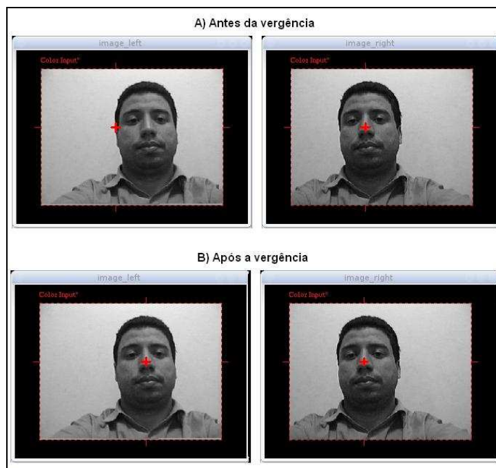
Figura 4-5 – Imagens (320x240) direita e esquerda de uma mesma cena. A cruz vermelha indica a posição para onde o olho está olhando, ou seja, o ponto da imagem projetado diretamente na fóvea. (A) Ao escolher um ponto na imagem direita, coordenada [132,135], o olho esquerdo se move para a posição correspondente, coordenada [132,135], fazendo com que o observador esteja "olhando para o infinito". (B) Após o processo de vergência os dois olhos estão orientados de forma que o ponto escolhido esteja sendo projetado diretamente na fóvea de cada retina. O olho direito continua na coordenada [132,135], enquanto que o olho esquerdo moveu para a coordenada [189,135] que é o ponto correspondente ao ponto focalizado pelo olho direito [132,135].
