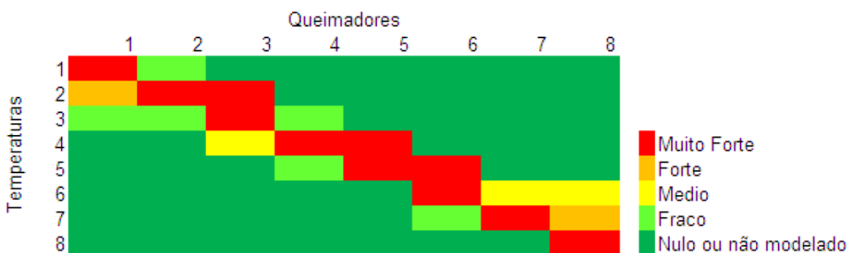
Figura 26 – Mapa de acoplamento entre os grupos de queima da Usina I
