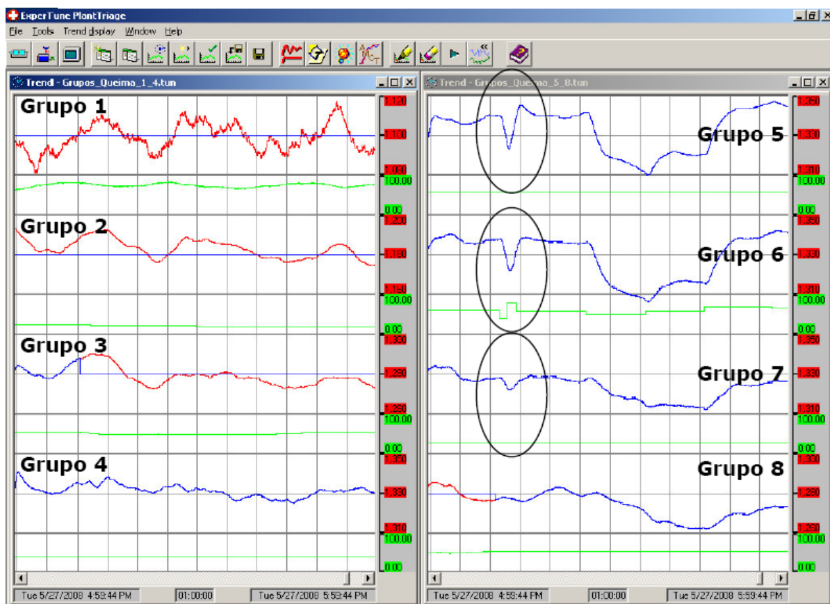
Figura 24 - Acoplamento do grupo 6 com os grupos 5 e 7
