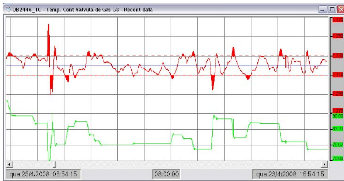
Figura 28 - Presença de banda morta no PID do Grupo de Queima 8 da Usina II.
