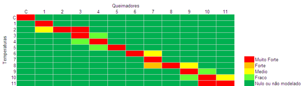
Figura 31 - Mapa de acoplamento entre os Grupos de Queima da Usina II
