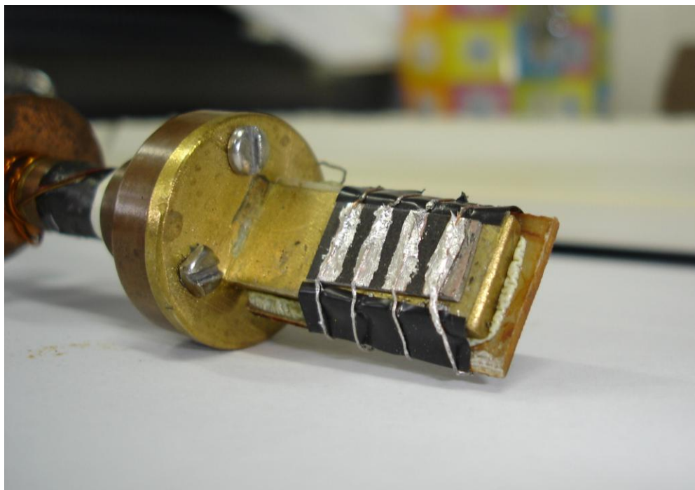
Figura 19 - Ponta de prova utilizada para fazer medidas de resistividade elétrica.
