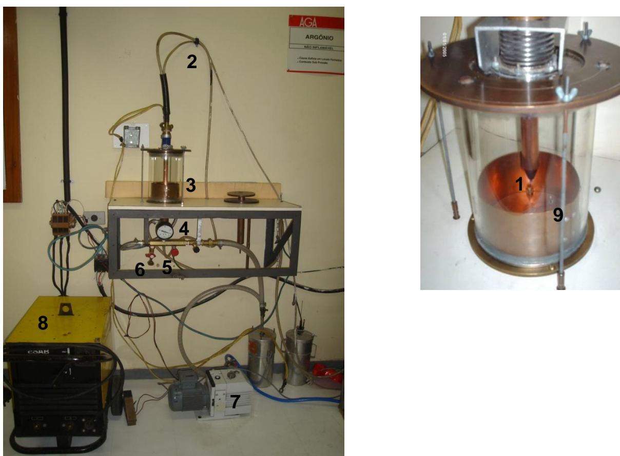
Figura 3.1 - Forno de Fusão a arco elétrico e seus componentes. (1) Haste móvel (eletrodo), (2) Refrigeração da haste e base, (3) Câmara de Fusão, (4) Vacuômetro, (5) Entrada de Argônio, (6) Entrada de Ar, (7) Bomba Mecânica (Vácuo), (8) Fonte de corrente DC, (9) Eletrodo da base.
